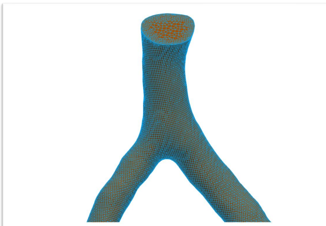
Slika 5.4. Mreža na ulazu u lijevu koronarnu arteriju pacijenta 1
