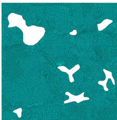
Slika 5.25 Mreža od 52734 konačna elementa homogenog modela 500x
