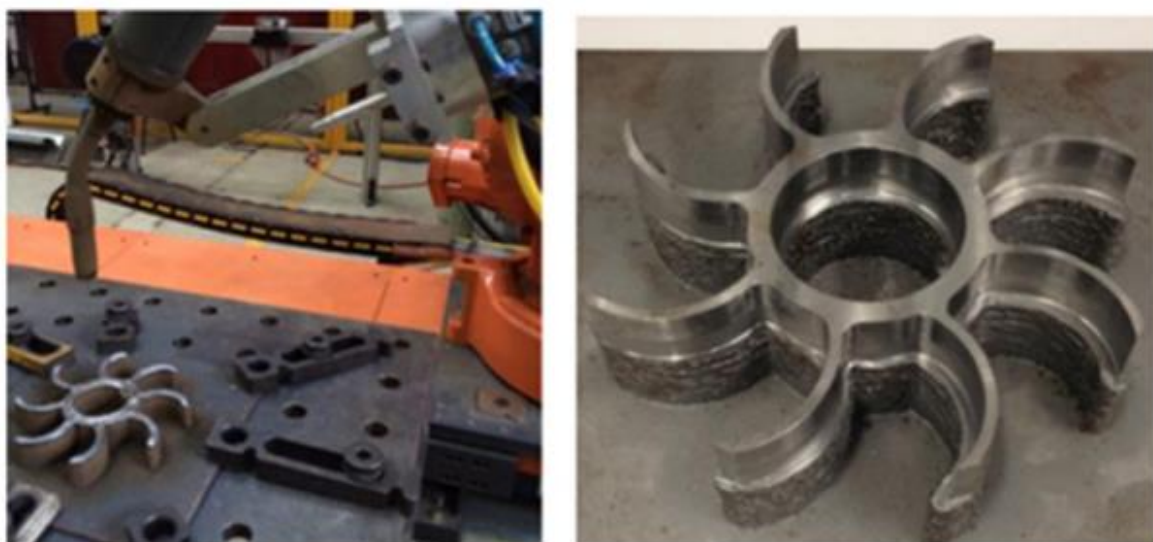
Slika 3. Izrada WAAM komada (lijevo), djelomično strojno obrađen komad (desno) [2]
