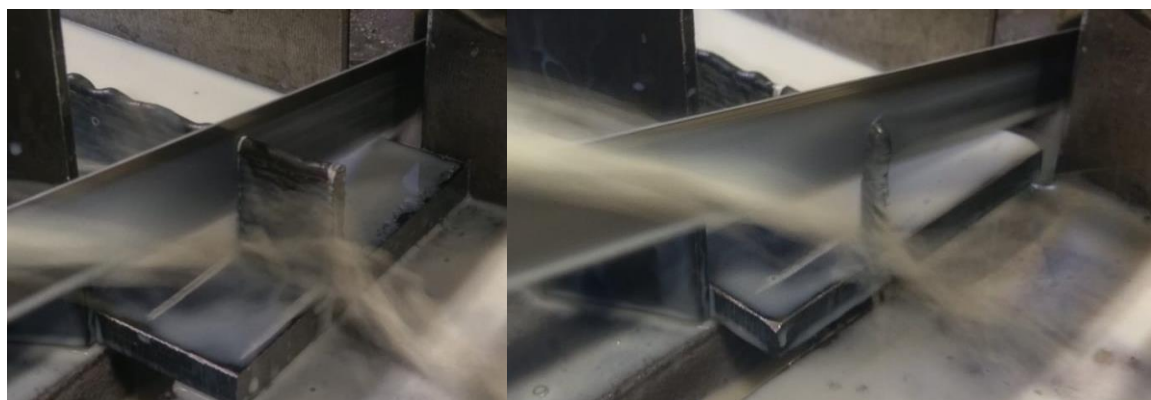
Slika 51. Odrezivanje ruba zida (desno), odrezivanje zida za mikro i makro analizu (lijevo)
