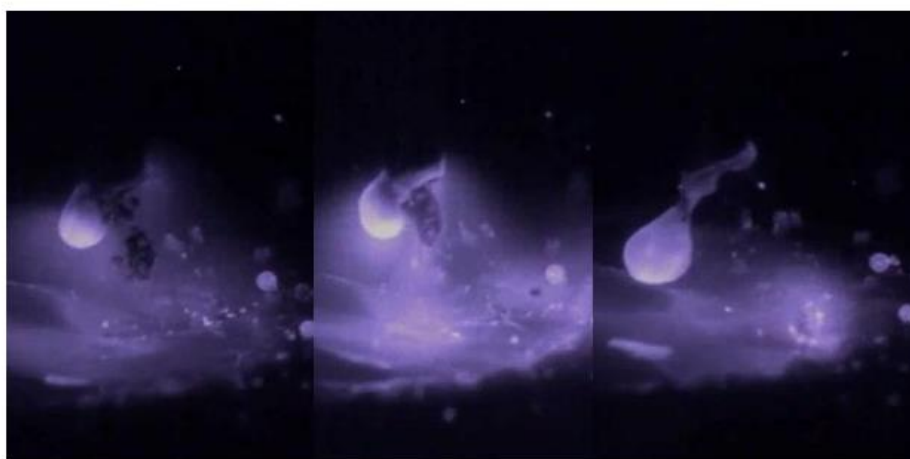
Slika 19. Stvarni prikaz prijenosa metala štrcajućim lukom [13]
