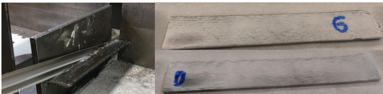
Slika 53. Rezanje zida od osnovne ploče (lijevo), zid sa nanesenim penetrantom (desno)
