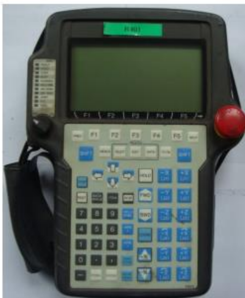
Slika 28. Privjesak za učenje ili kontroler [16]
