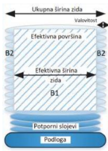
Slika 6. Zid izrađen WAAM postupkom [3]
