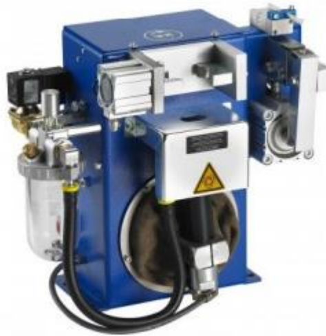
Slika 31. Oprema za čišćenje pištolja [16]
