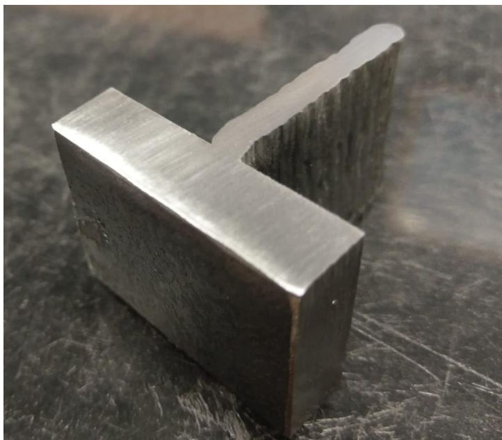
Slika 52. Obradak nakon brušenja sa brusnim papirom grubosti 600
