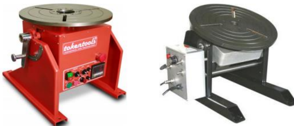
Slika 29. Jednoosni i dvoosni uređaj za pozicioniranje [16]
