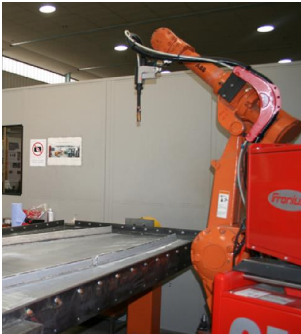
Slika 2. Klasični WAAM sustav [2]
