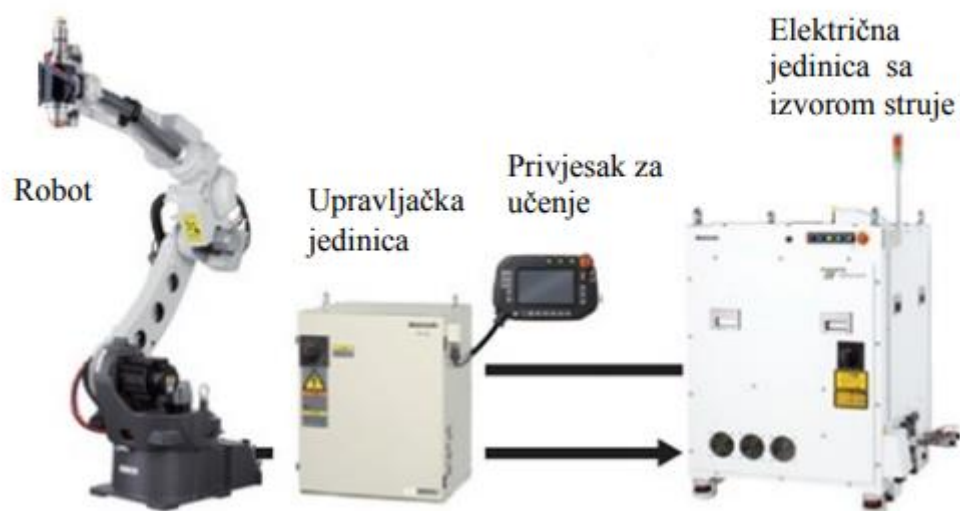
Slika 26. Sustav robotiziranog zavarivanja [16]
