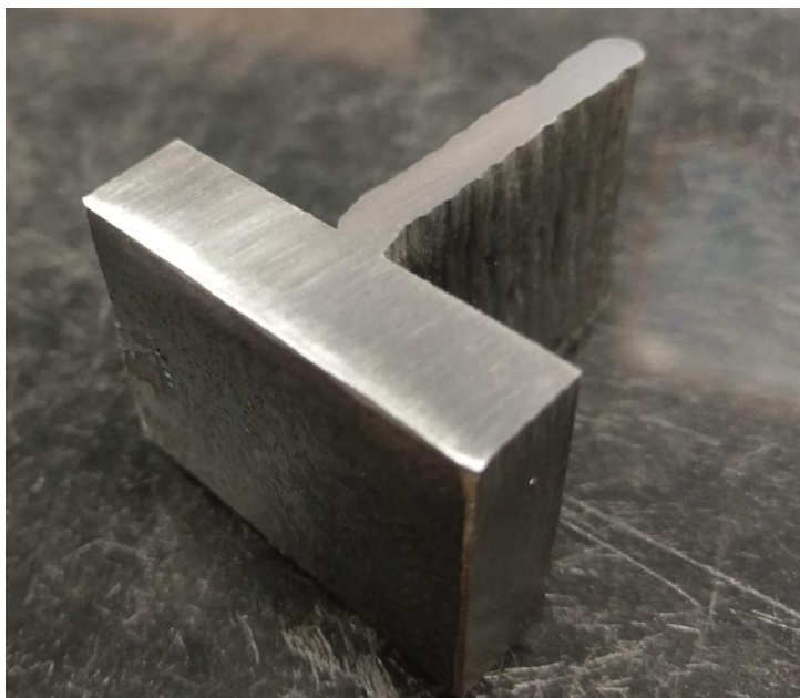
Slika 52. Obradak nakon brušenja sa brusnim papirom grubosti 600
