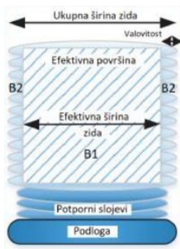
Slika 6. Zid izrađen WAAM postupkom [3]
