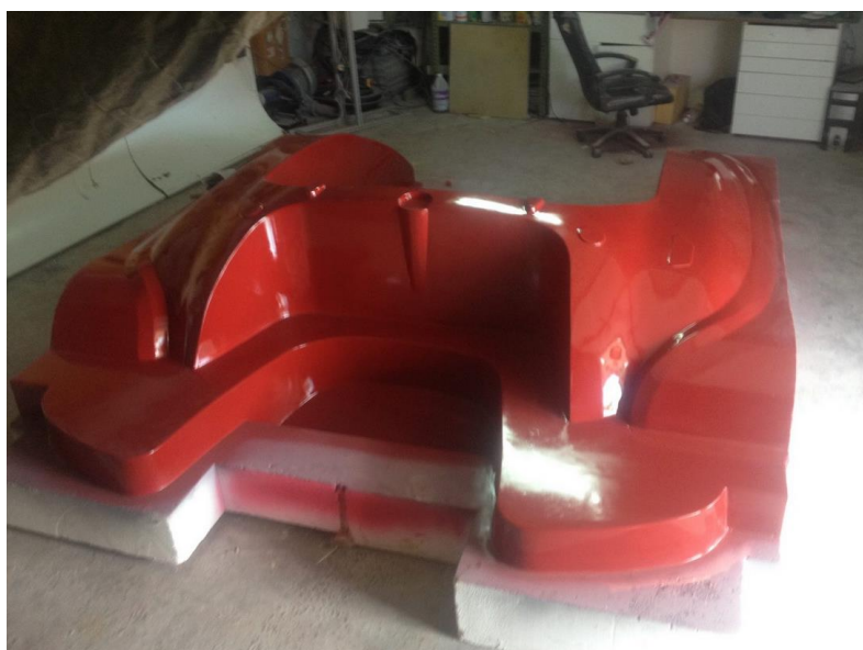
Slika 18. Komad napravljen na Kuka KR1250 robotu [19]
