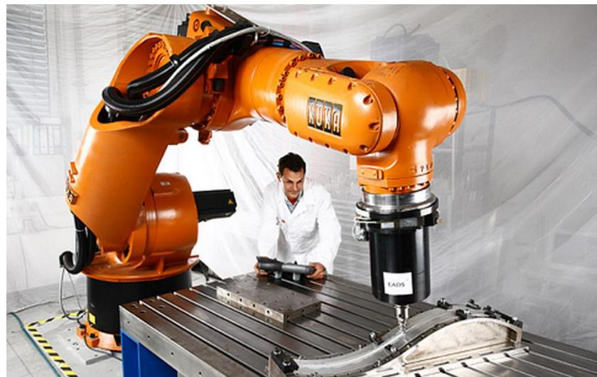
Slika 3. Industrijski robot vrši operaciju glodanja – proizvođač KUKA [5]
