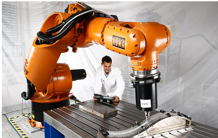
Slika 3. Industrijski robot vrši operaciju glodanja – proizvođač KUKA [5]
