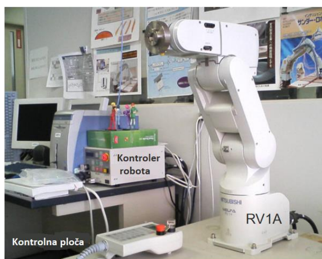
Slika 15. Industrijski robot RV1A [14]
