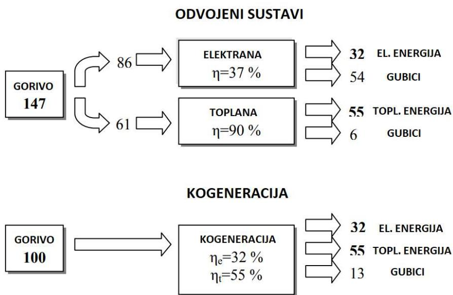
Slika 1. Usporedba efikasnosti pojedinačnih sustava i kogeneracije
