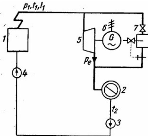
**Slika 3.** Shema postrojenja s protutlačnom turbinom [5]
