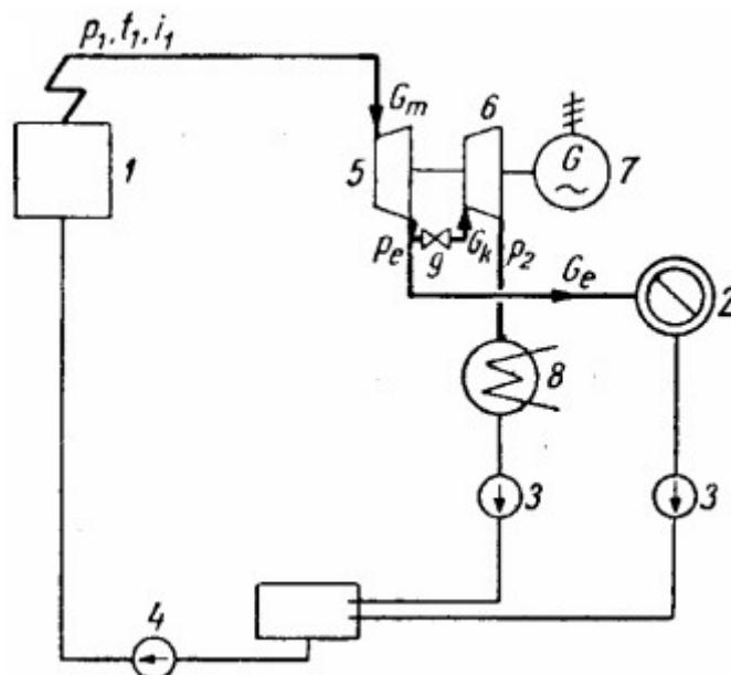
Slika 2. Shema postrojenja s kondenzacijskom turbinom [5]
