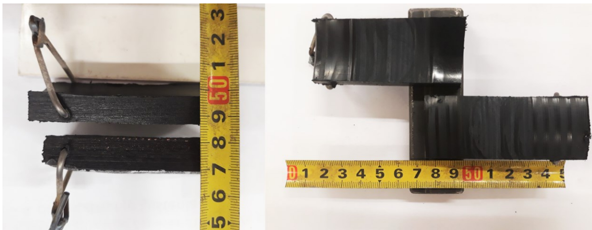
Slika 46. Uzorak 2 desno nakon kidanja
