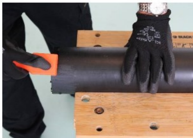
Slika 26. Struganje površine cijevi [20]
