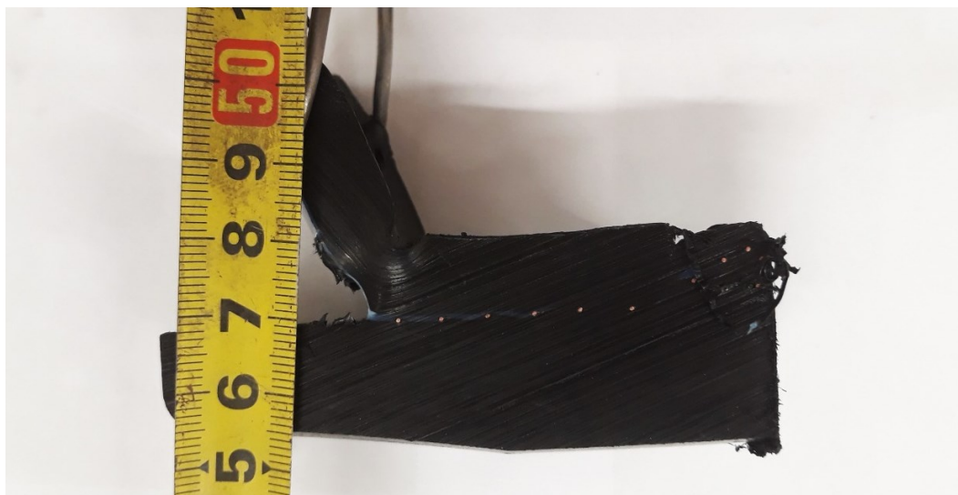
Slika 42. Uzorak 1 desno nakon ljuštenja
