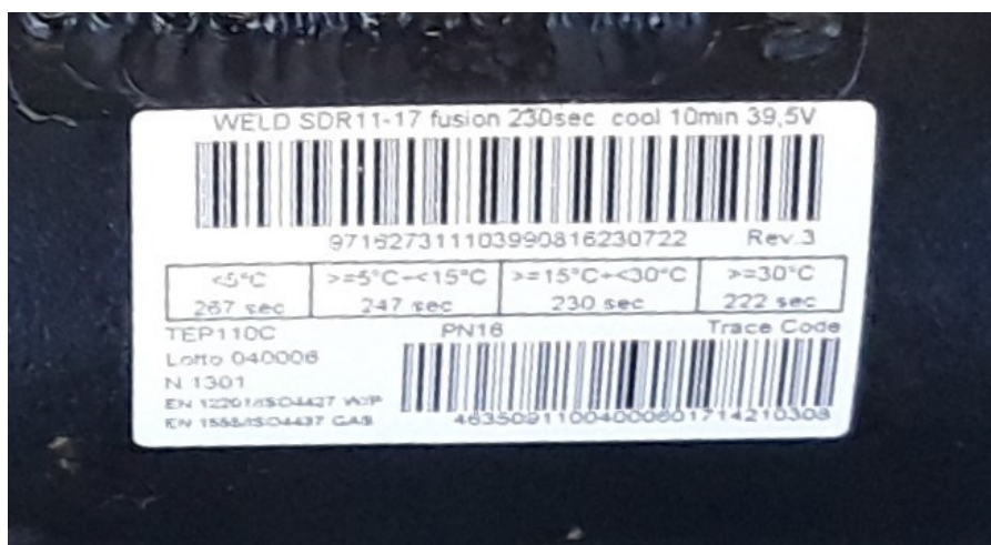
Slika 25. Etiketa i bar kod na elektrofuzijskoj spojnici
