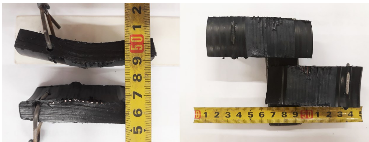
Slika 44. Uzorak 2 lijevo nakon kidanja
