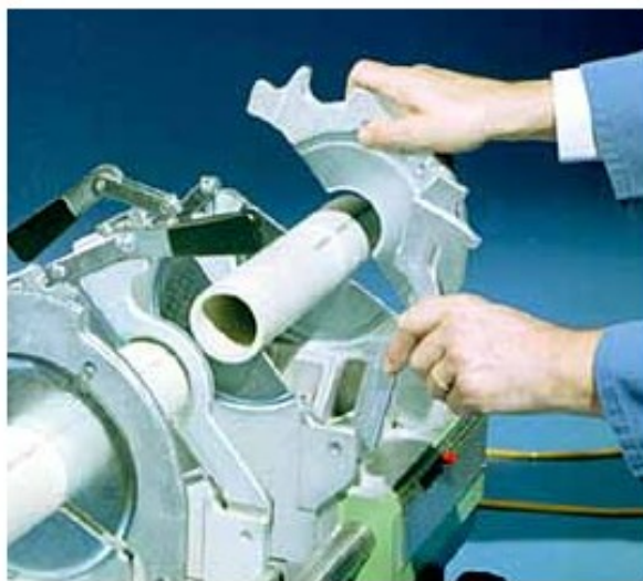
Slika 13. Pričvršćivanje i poravnavanje cijevi [13]
