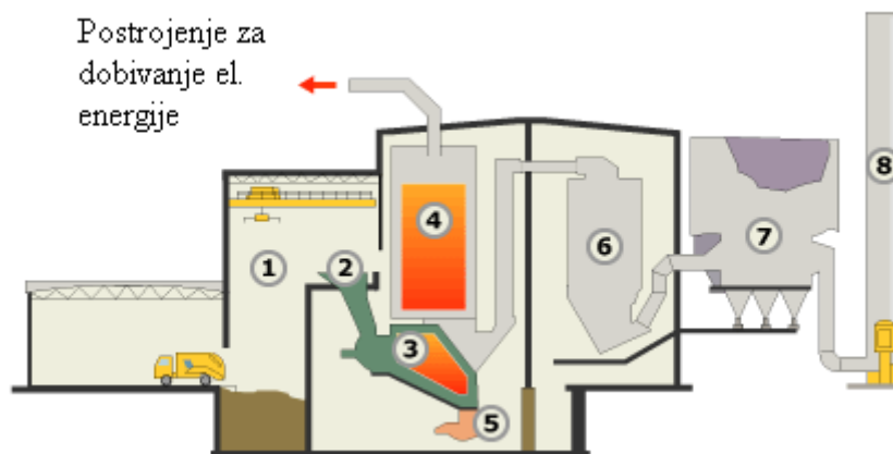
Slika 2.3. Postrojenje za izgaranje netretiranog otpada
