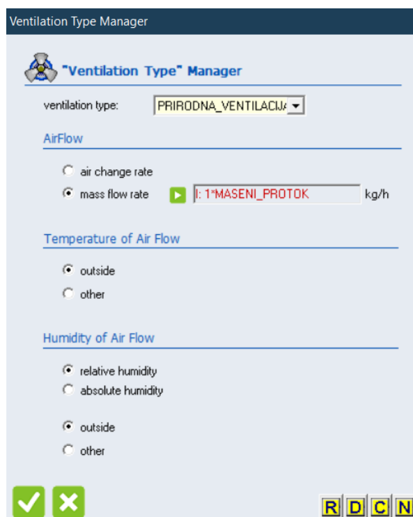
Slika 27. Definiranje prirodne ventilacije unutar TRNBuilda
