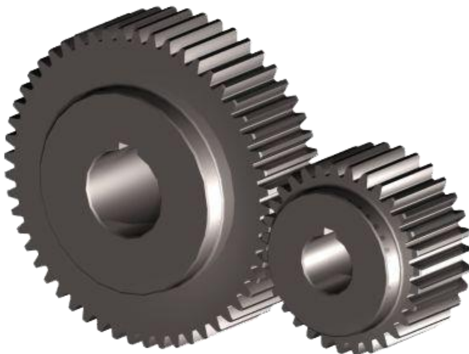
Slika 1. Zupčani par s ravnim zubima [1]
