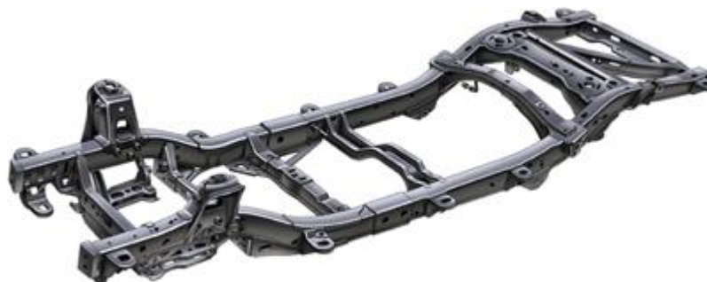
Slika 3.13. Donja šasija poprečnih i uzdužnih nosača [18]
