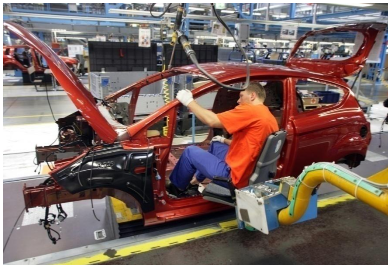
Slika 3.12. Montaža karoserijskih dijelova i kontrola [22]
