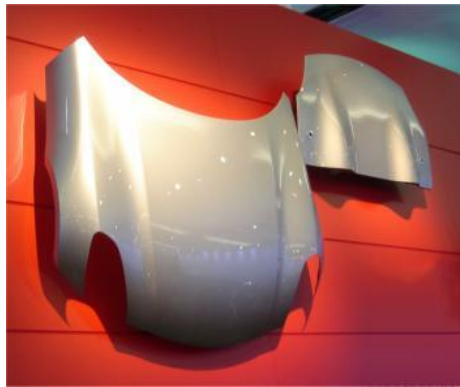
Slika 3.16. Hydrooblikovan prednji i zadnji poklopac karoserije [18]
