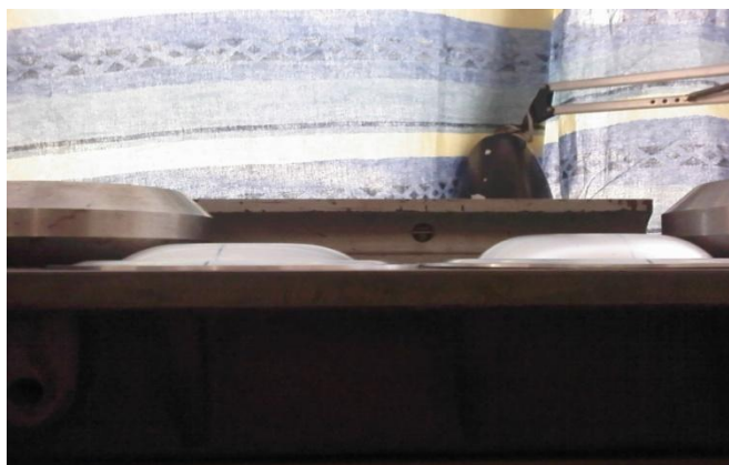
Slika 6.7. Rondela 32( lijeva pri tlaku 36 bara) i 33(desna pri tlaku 53 bara) pri modificiranom hidrauličnom udubljivanju
