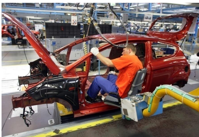
Slika 3.12. Montaža karoserijskih dijelova i kontrola [22]
