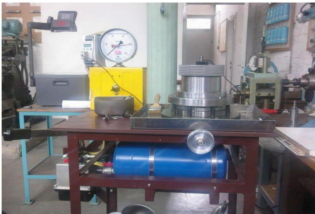
**Slika 6.3.** *Naprava za modificirano hidraulično udubljivanje*
