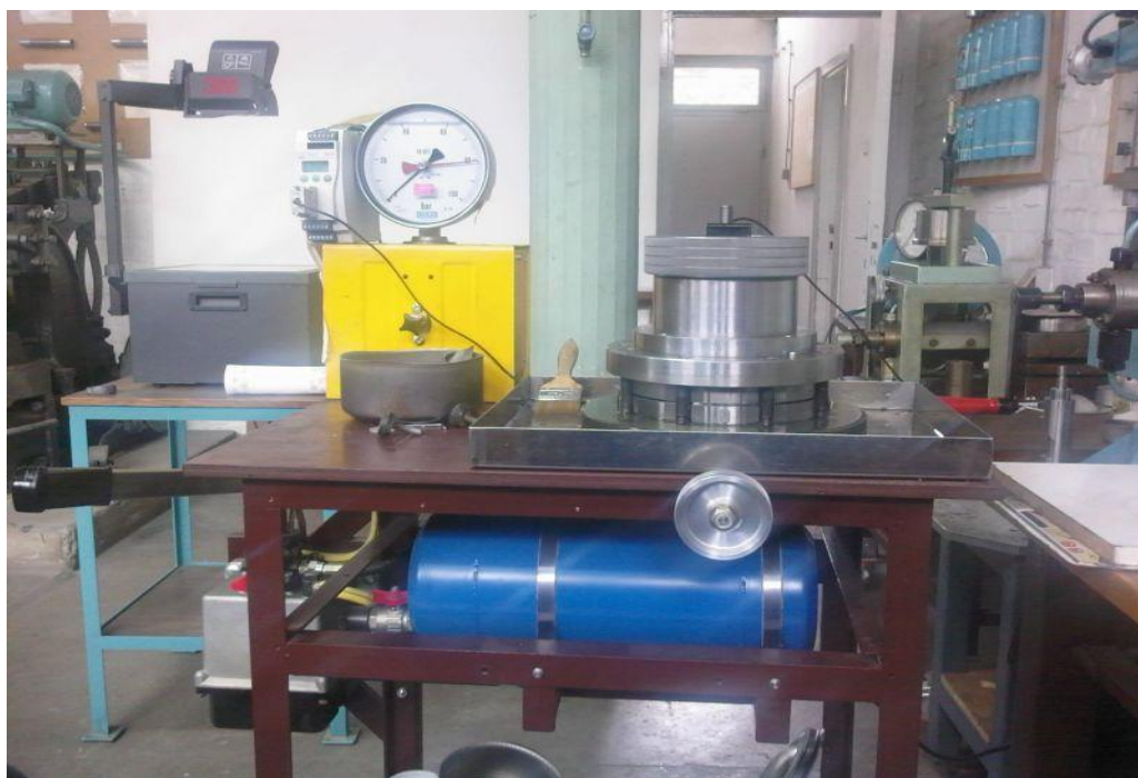
Slika 6.3. Naprava za modificirano hidraulično udublivanje
