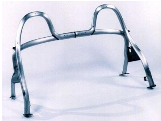
Slika 3.19. Konstrukcija koja sprečava uvijanje karoserije kabrioleta i štiti glave putnika [18]
