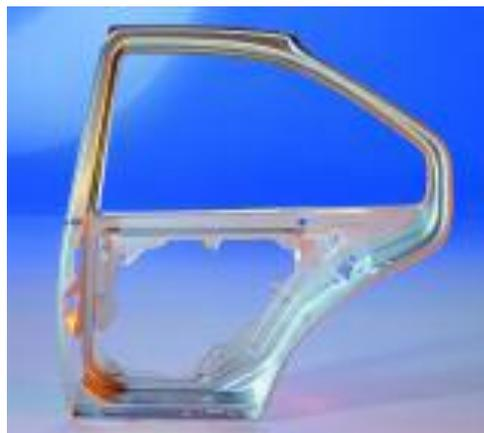
**Slika 3.4.** Unutrašnja profilirana površina vrata automobila
