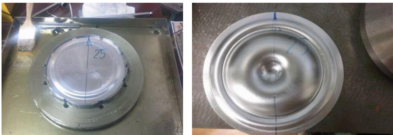
Slika 6.1. Rondela 25 prije i poslije modificiranog hidrauličnog udubljivanja
