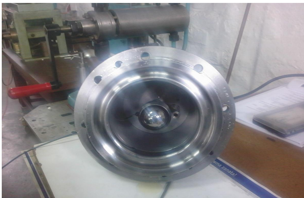
Slika 6.4. Sfera koja sprečava slobodno oblikovanje lima
