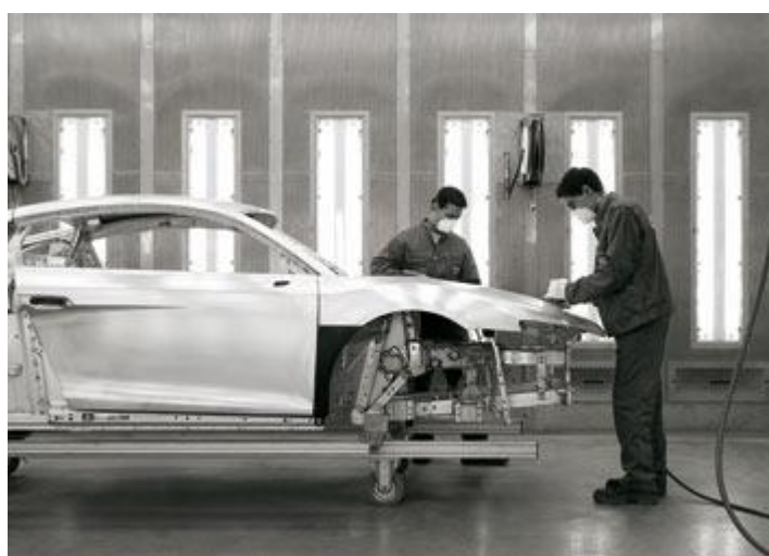
Slika 3.9. Montaža karoserije i priprema za lakiranje
