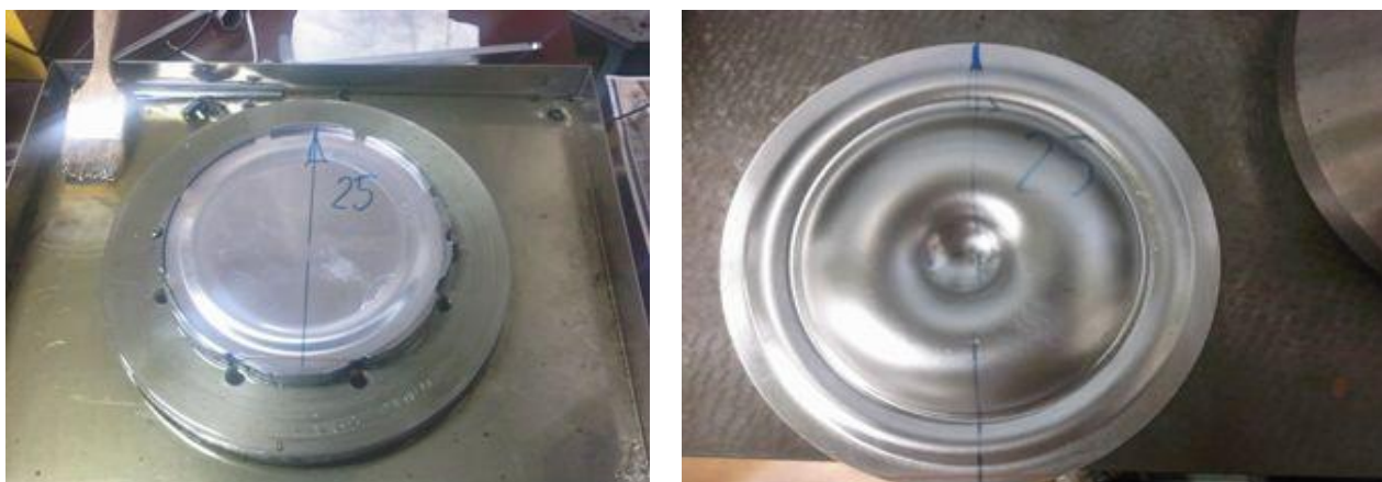
Slika 6.1. Rondela 25 prije i poslije modificiranog hidrauličnog udubljivanja
