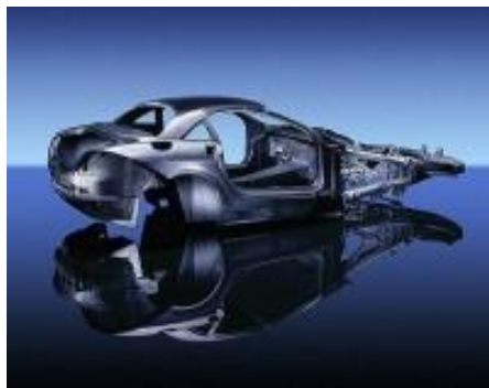
Slika 3.1. Kevlarska šasija Mercedesa SLR McLaren
