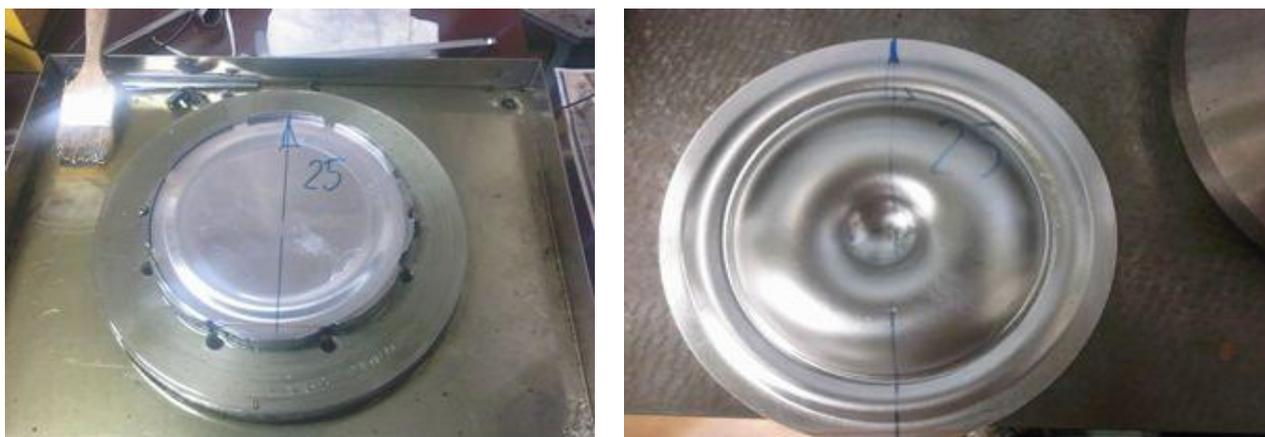
**Slika 6.1.** Rondela 25 prije i poslije modificiranog hidrauličnog udubljivanja
