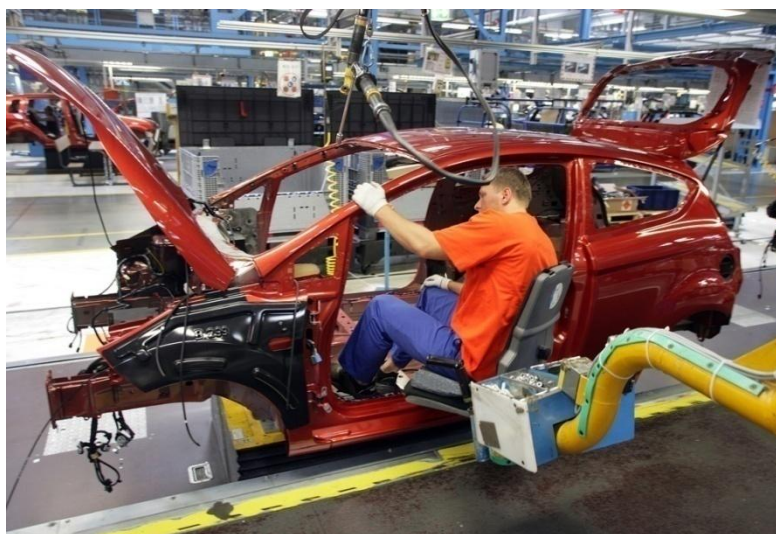
Slika 3.12. Montaža karoserijskih dijelova i kontrola [22]
