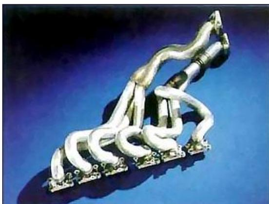
**Slika 3.15.** *Hidrooblikovana ispušna grana 6 cilindarskog motora [18]*
