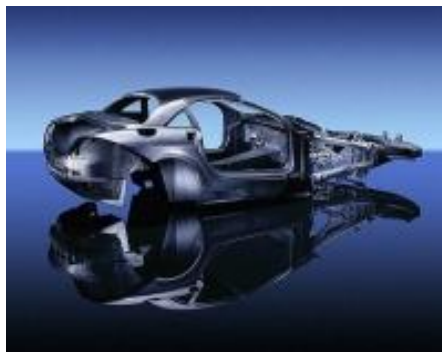
Slika 3.1. Kevlarska šasija Mercedes SLR McLaren
