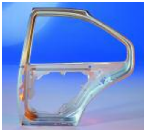
Slika 3.4. Unutrašnja profilirana površina vrata automobila
