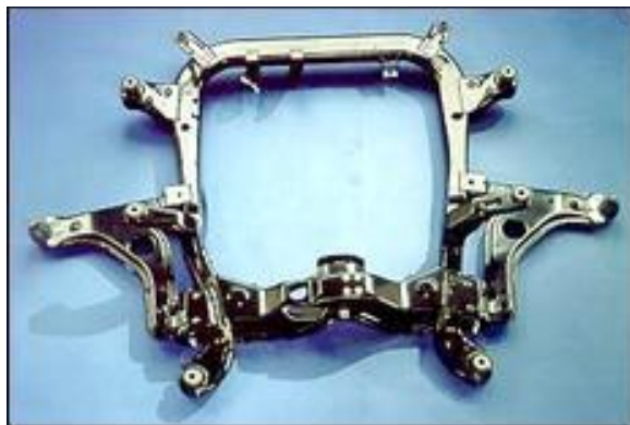
Slika 3.14. Hidrooblikovani okvir šasije na koji se oslanja motor sa parom vilica
