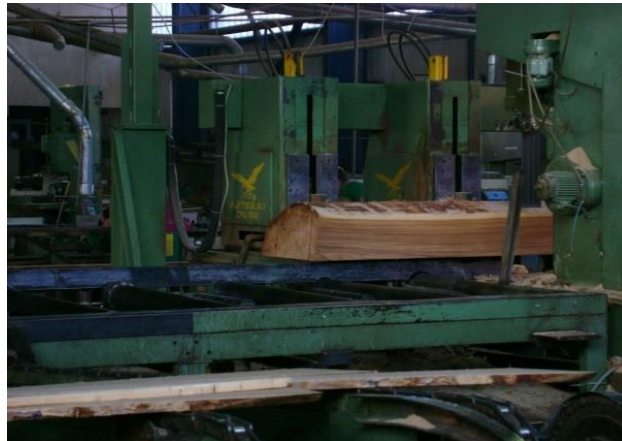
Slika 6.1. Obrada na tračnoj pili trupčari [11]
