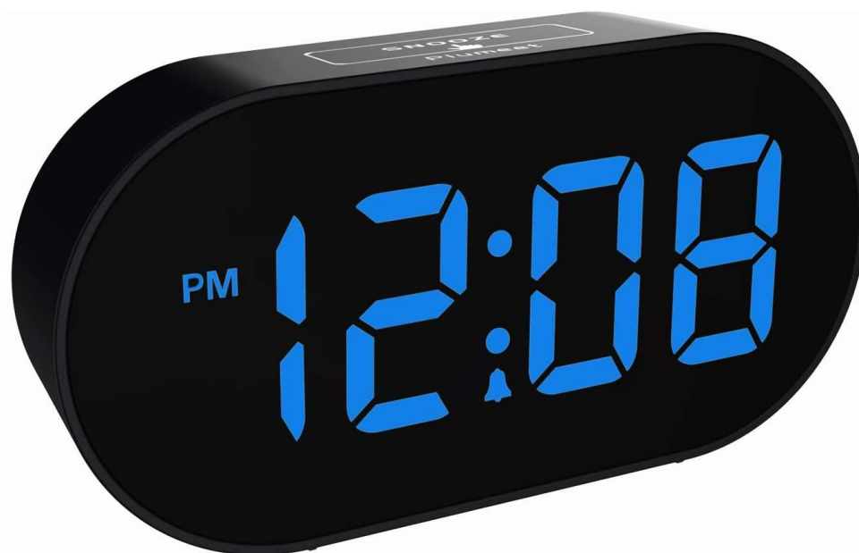
Slika 1. Realizacija LED sata korištenjem 7 - segmentnog prikaznika [8]
