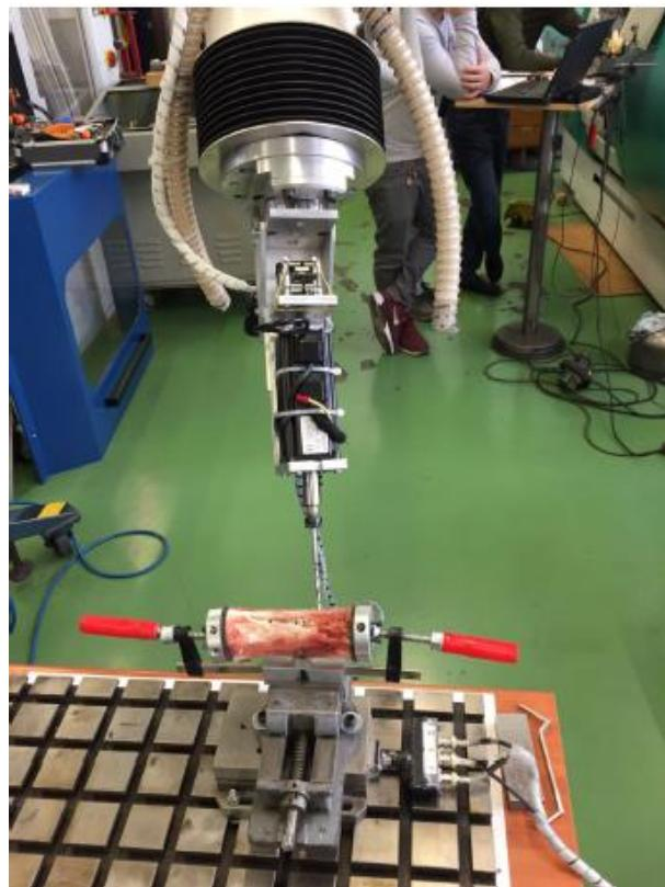
Slika 1.4 Ispitivanje sustava bušenjem koštanog tkiva [5]
