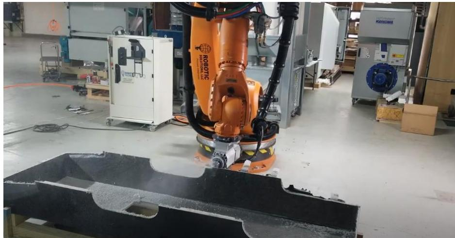
Slika 1.1 Obrada kompozitnog materijala 6 osnim robotom [2]
