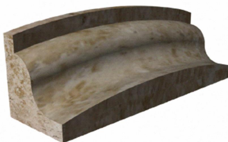
Slika 8. Primjer izratka obrađenog na troosnom CNC stroju [12]
