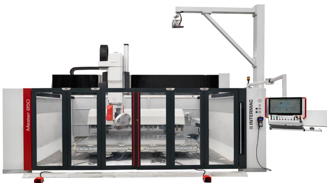
Slika 9. 5-osni CNC obradni centar za obradu kamena [13]
