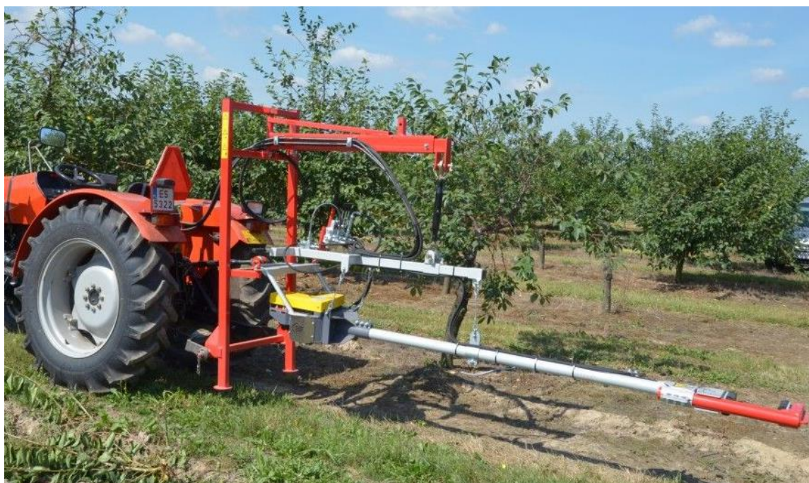
Slika 12. Tresač stabla Jagoda JPS Pestka
