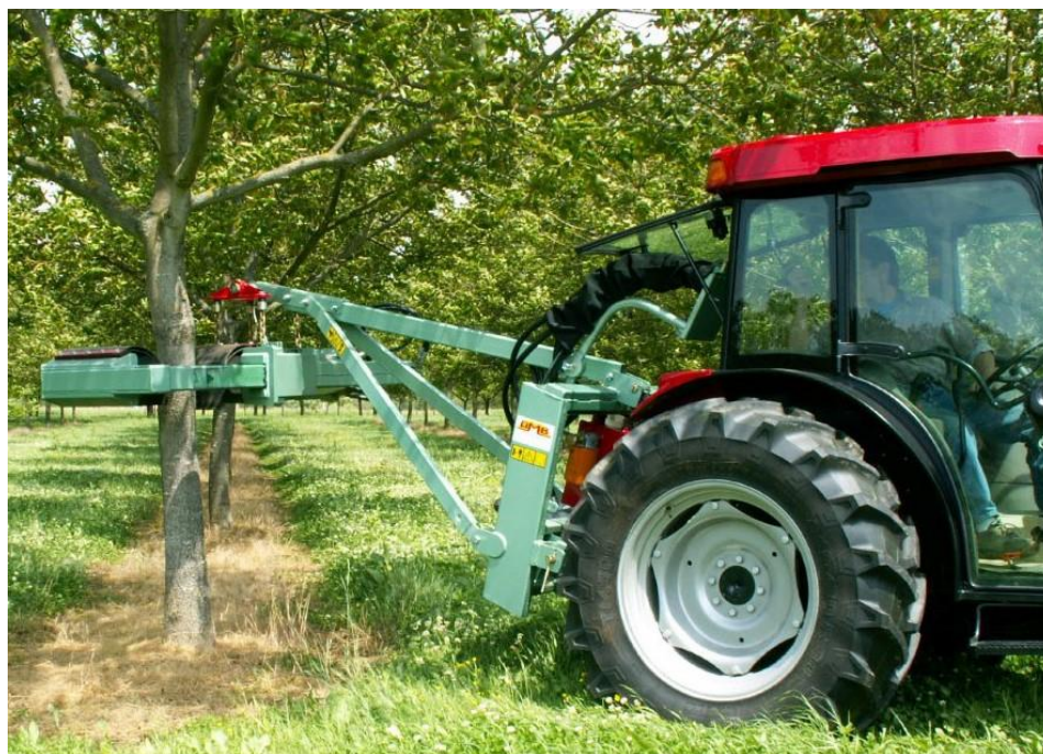
Slika 11. Tresač stabla AMB Rousset VHD
