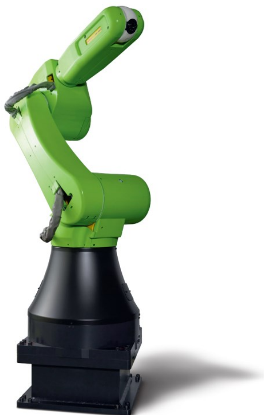
Slika 6. Industrijski robot FANUC CR-35iA [14]
