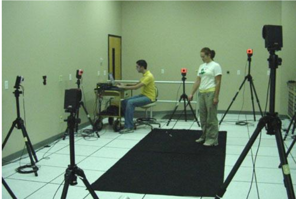
Slika 1. Prikaz 3D sustava za snimanje
