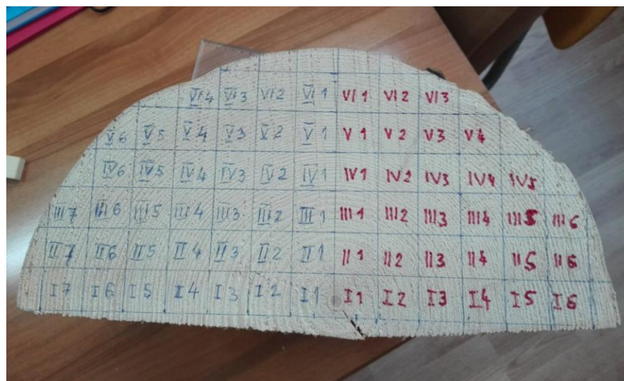
Slika 24. Raspored uzoraka na poprečnom presjeku debla
