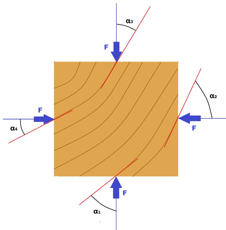
Slika 34. Shematski prikaz mjerjenja kuta
