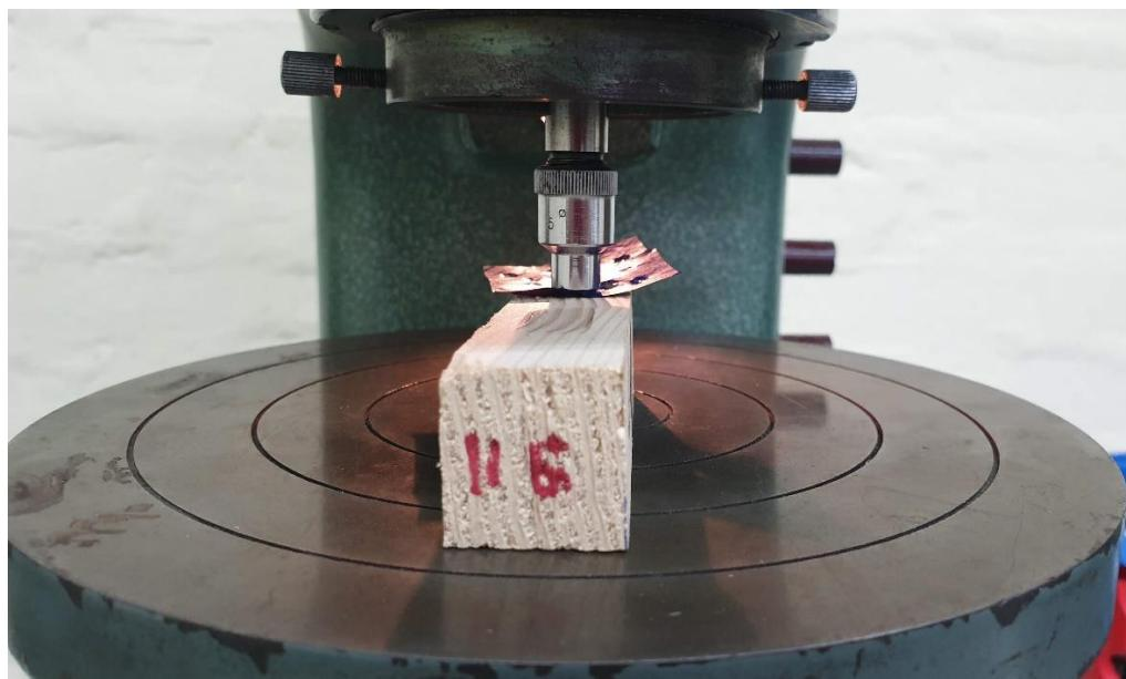
**Slika 30. Položaj ispitnog uzorka pod opterećenjem**
