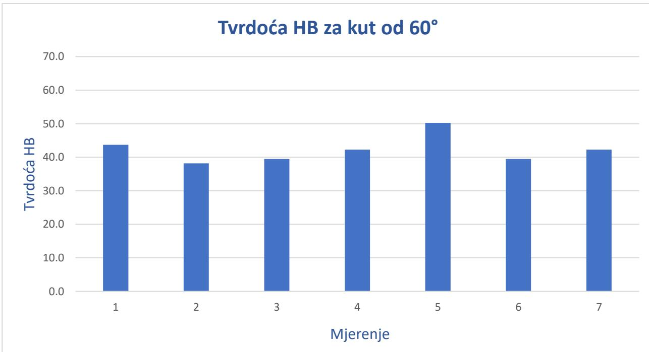
**Slika 40.** Rasipanje vrijednosti tvrdoče za kut  $60^\circ$
