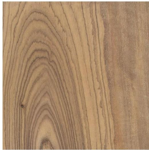
**Slika 19.** Mikrostruktura drva masline, tangencijalni presjek [23]
