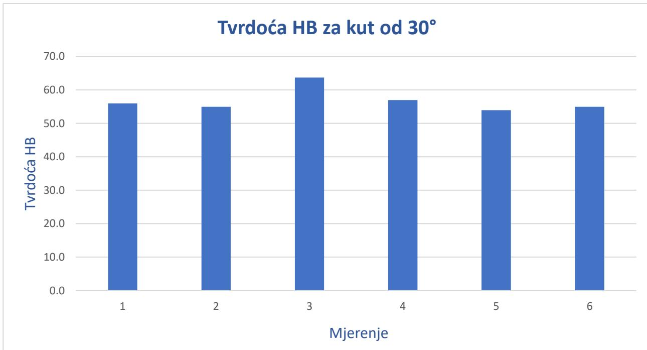
Slika 38. Rasipanje vrijednosti tvrdoće za kut  $30^\circ$
