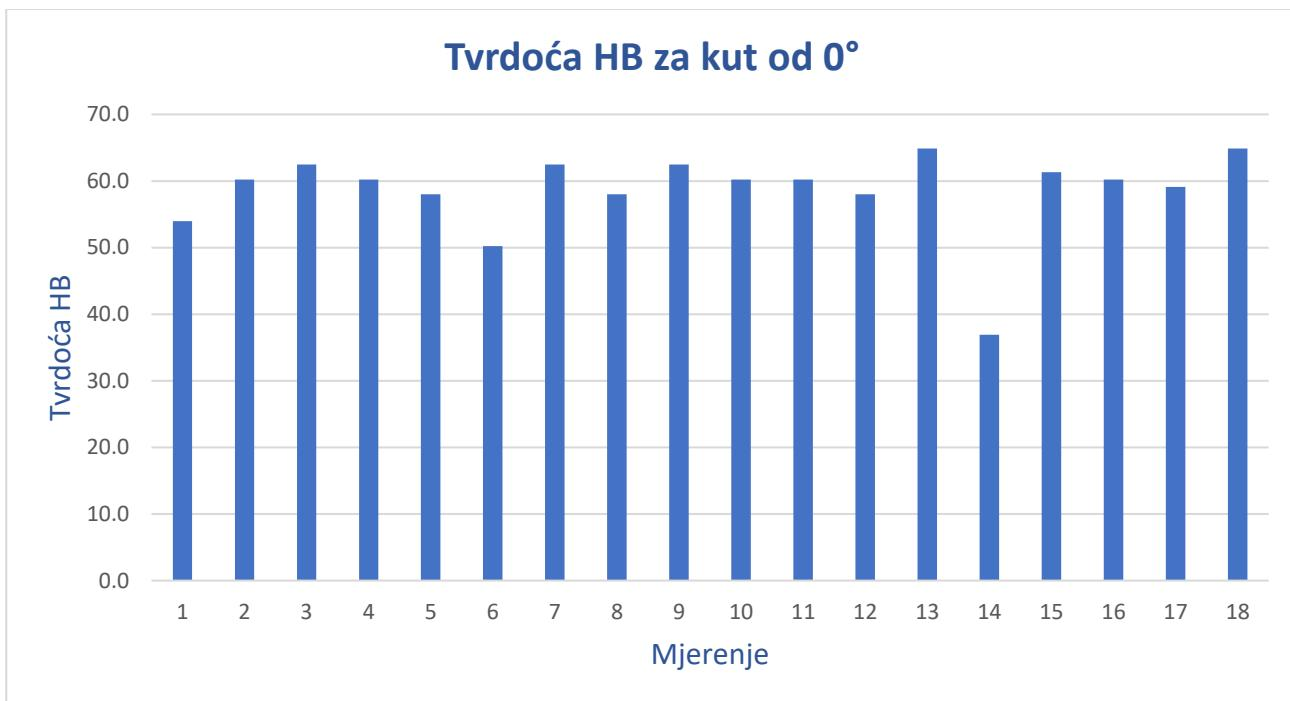
Slika 37. Rasipanje vrijednosti tvrdoće za kut  $0^\circ$
