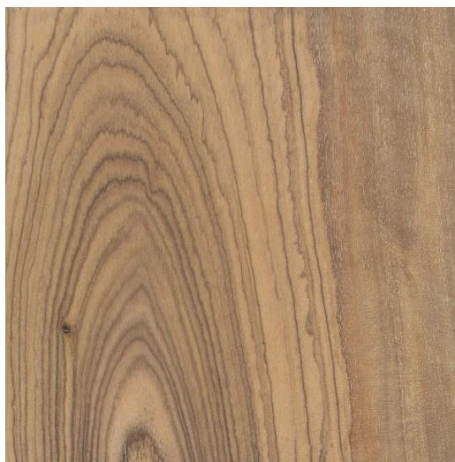
Slika 19. Mikrostruktura drva masline, tangencijalni presjek [23]
