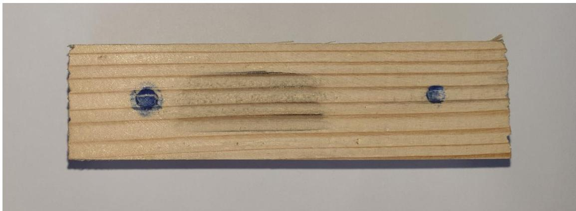
Slika 32. Otisci na uzorku nakon mjerena tvrdoće
