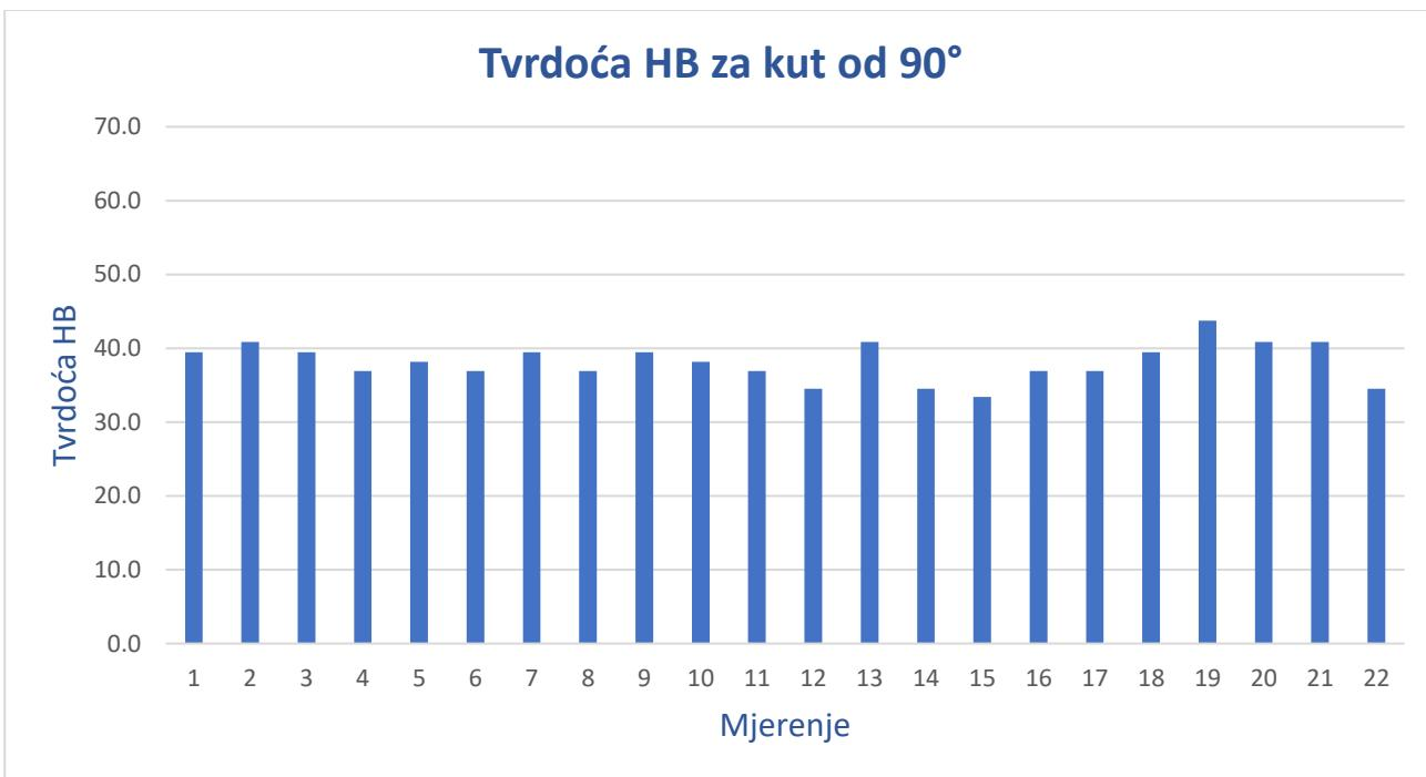
Slika 41. Rasipanje vrijednosti tvrdoće za kut  $90^\circ$
