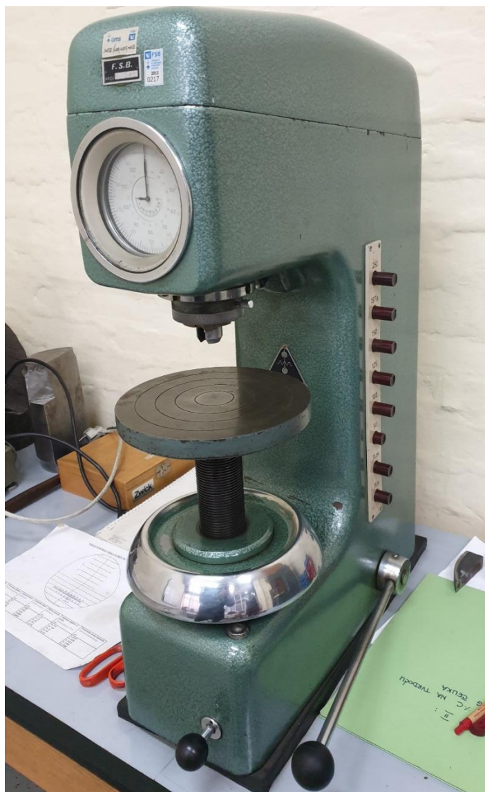
Slika 29. Uređaj za mjerenje tvrdoće Brinellovom metodom
