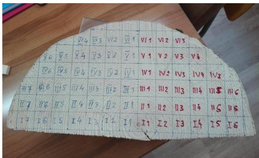
Slika 24. Raspored uzorka na poprečnom presjeku debla
