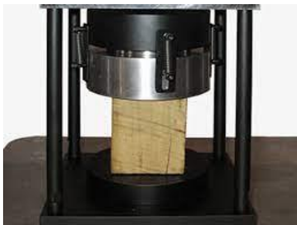
Slika 12. Ispitivanje tlačne čvrstoće [15]
