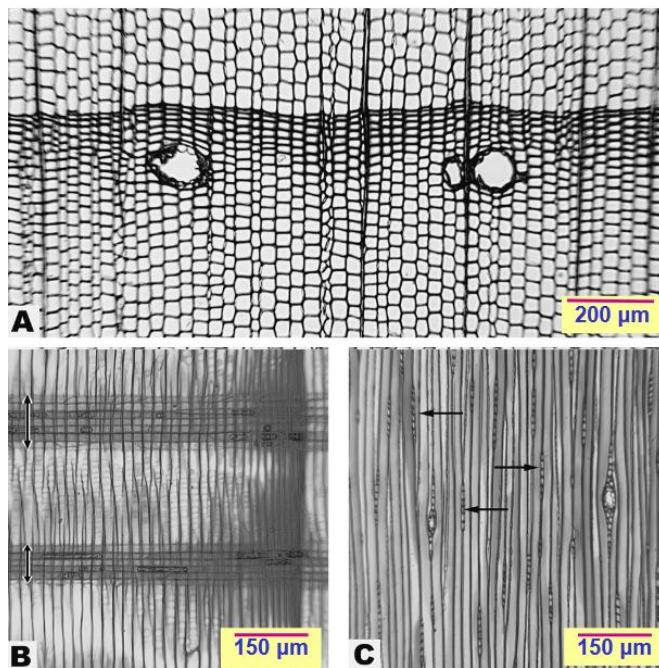
Slika 3. Karkateristični presjeci kroz četinjaču: A-poprečni, B-radijalni, C-tangencijalni [3]
