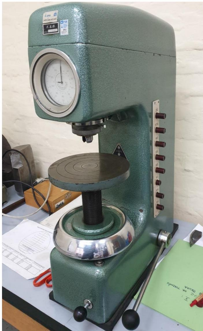
Slika 29. Uredaj za mjerjenje tvrdoće Brinellovom metodom
