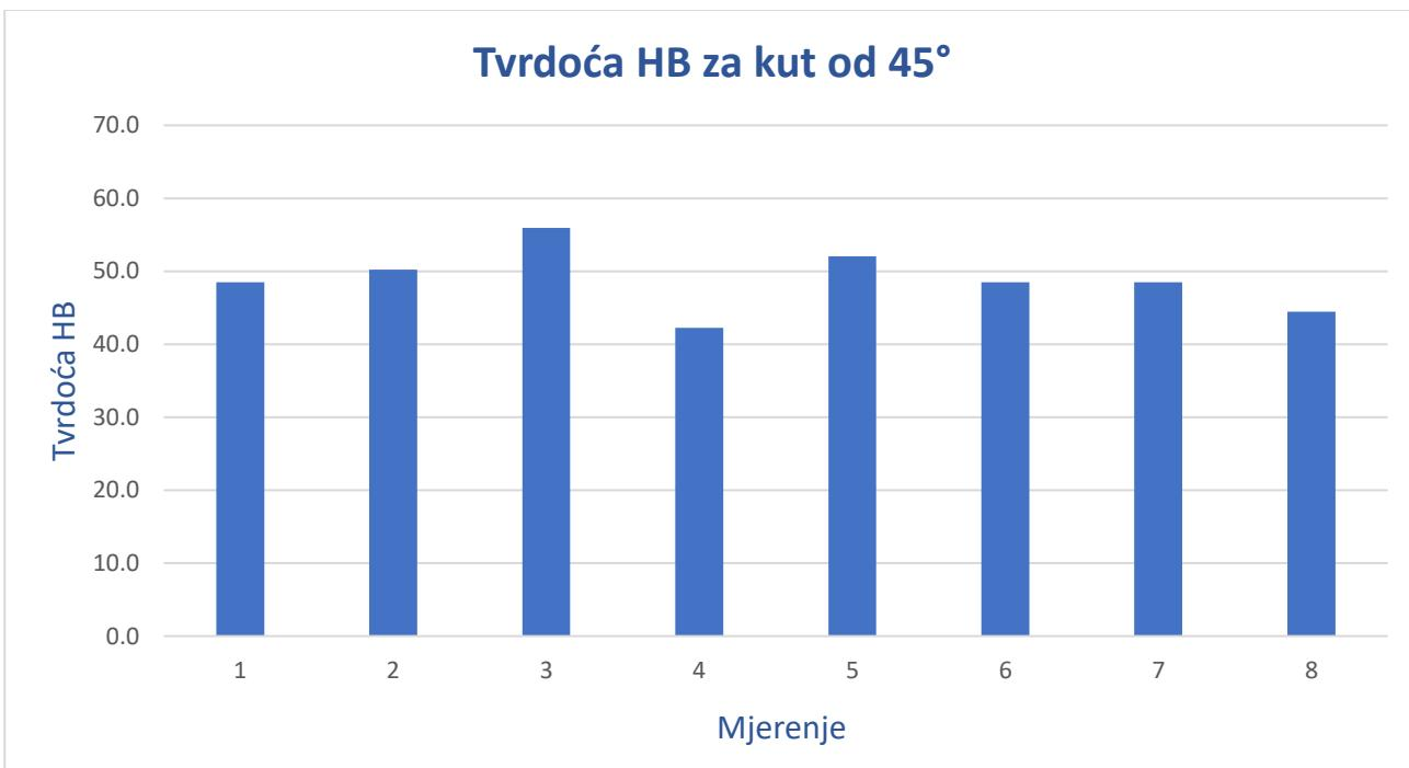
**Slika 39.** Rasipanje vrijednosti tvrdoče za kut  $45^\circ$
