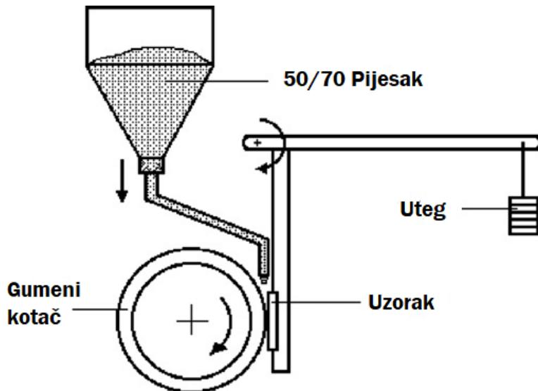
Slika 17. Shematski prikaz metode "suhi pijesak – gumeni kotač" [19]
