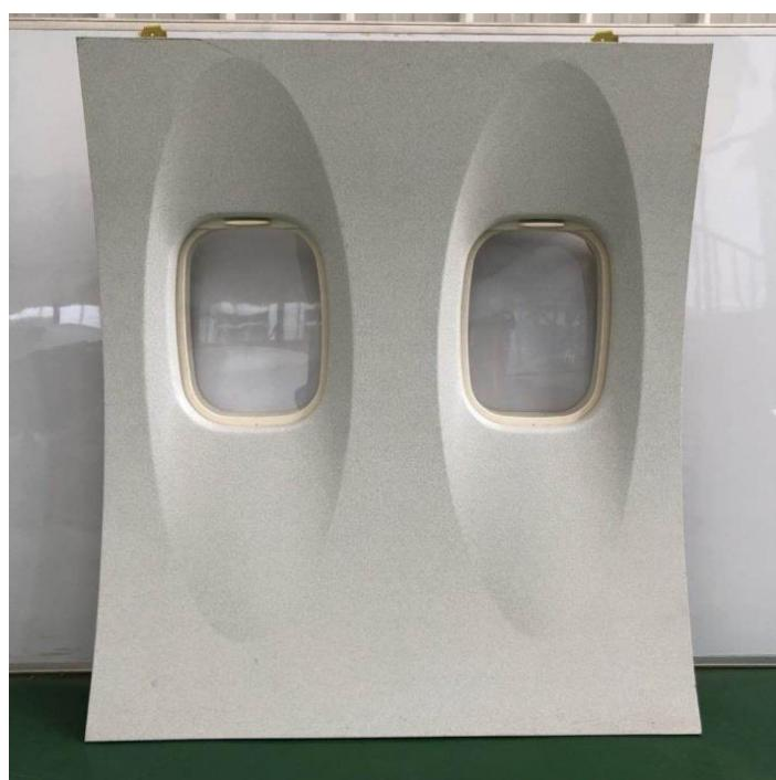
**Slika 12. Unutarnja ploča zrakoplova MA600 [35]**
