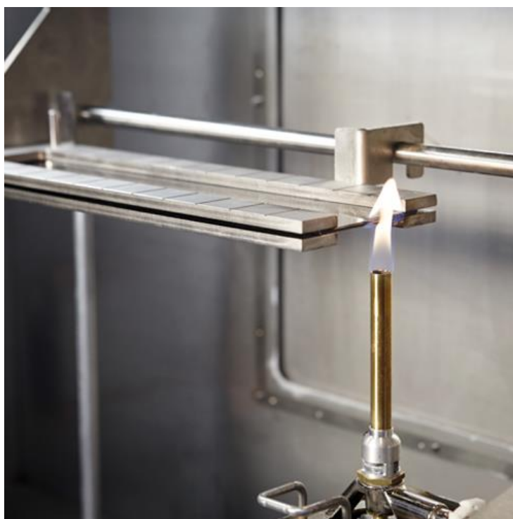
Slika 18. Horizontalni test gorenja Bunsenovim plamenikom [45]
