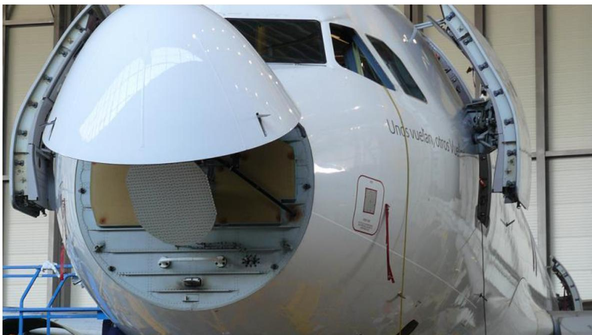
Slika 10. Radarska kupola na zrakoplovu [32]
