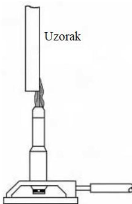
Slika 17. Vertikalni test gorenja Bunsenovim plamenikom [44]
