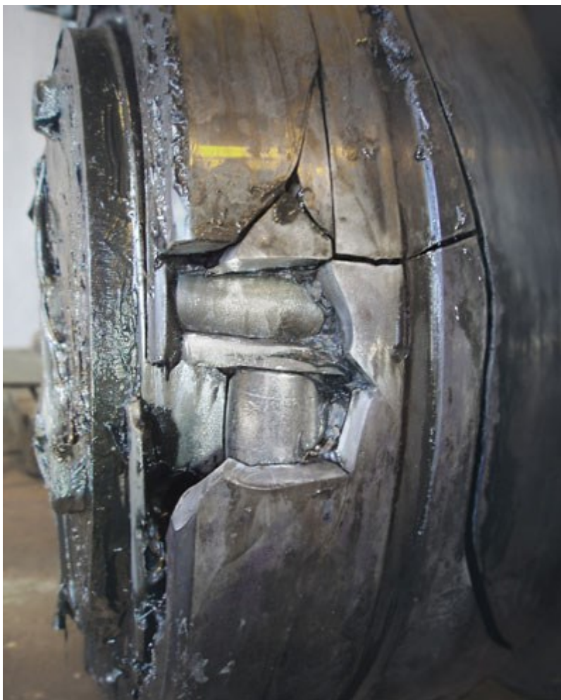
Slika 4. Pokvaren ležaj koji više nije u funkciji [7]
