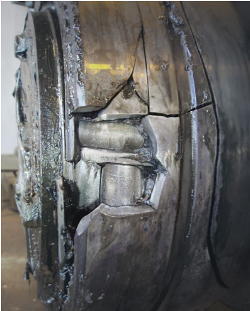
Slika 4. Pokvaren ležaj koji više nije u funkciji [7]
