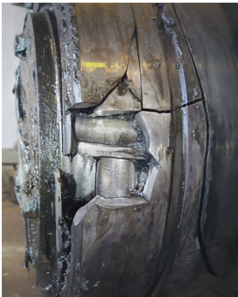
Slika 4. Pokvaren ležaj koji više nije u funkciji [7]
