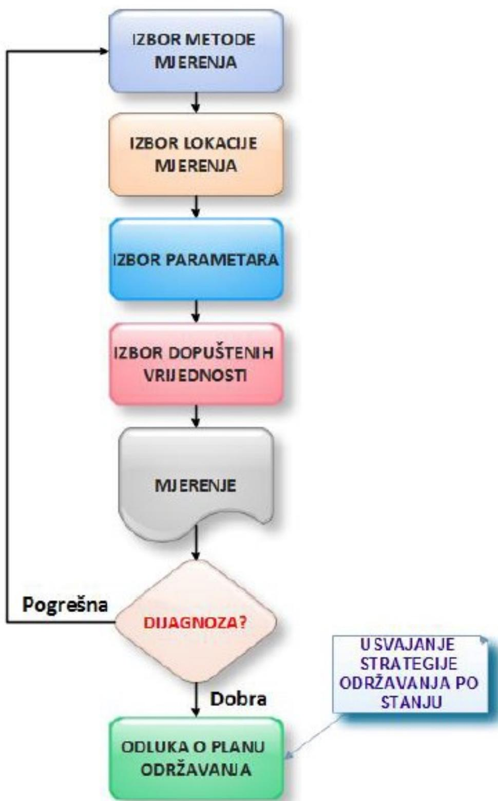
Slika 8. Postupak uvodenja održavanja po stanju kontrolom parametara [1]
