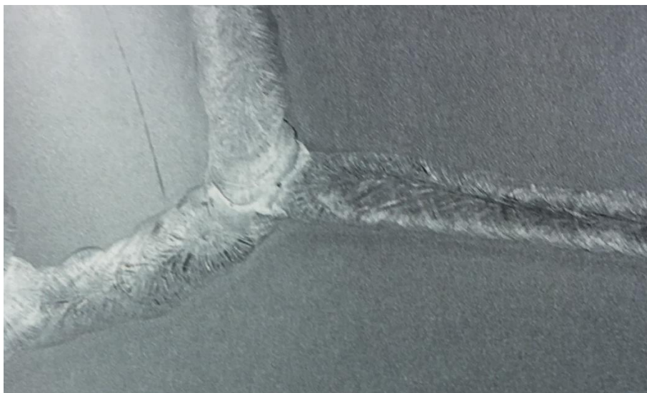
Slika 29: Izgled zavarenog spoja nakon kemijske obrade površine [29]
