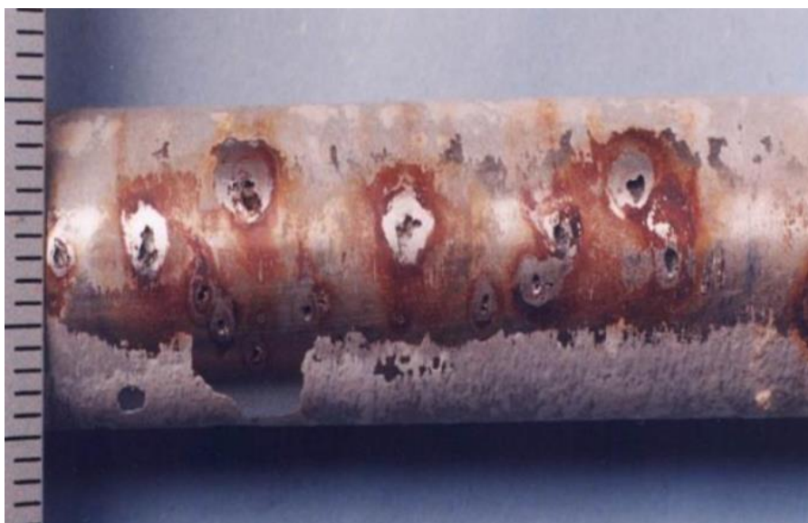
Slika 4: Zaštitna cijev grijača bojlera AISI 304 [3]
