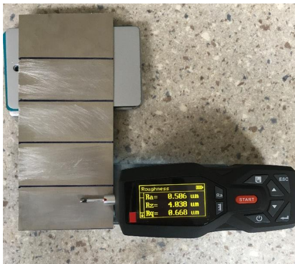
Slika 36: Mjerenje hrapavosti površine
