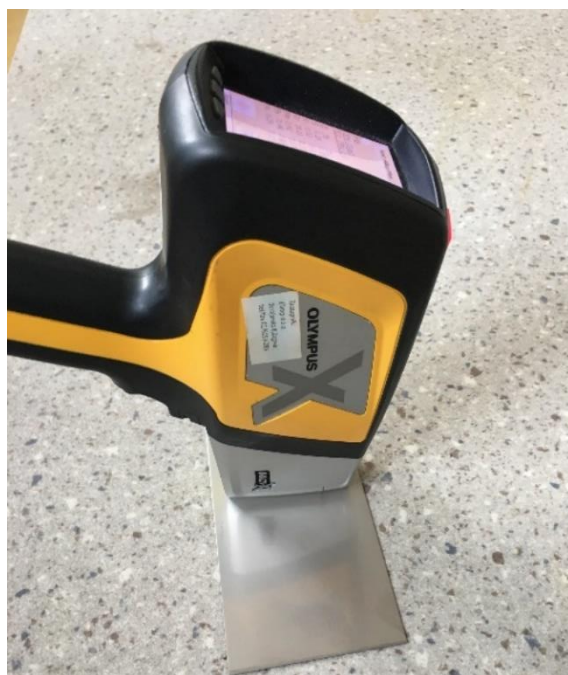
Slika 33: Ispitivanje kemijskog sastava uzoraka XRF metodom
