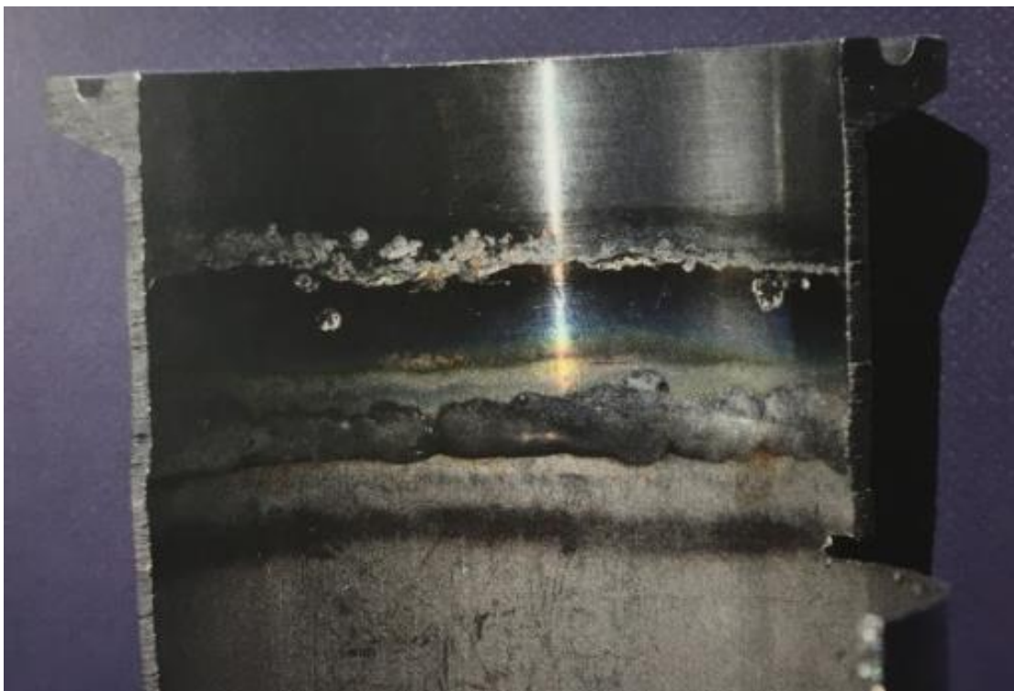
Slika 17: Rupičasta korozija na pobojenoj površini cijevi [29]
