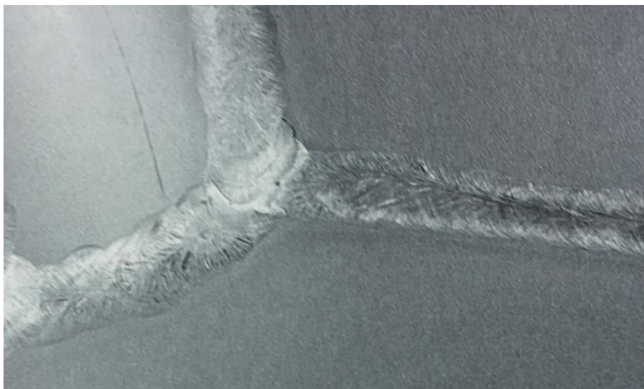
Slika 29: Izgled zavarenog spoja nakon kemijske obrade površine [29]
