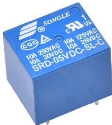
Slika 3-6 Relej upravljačke pločice
