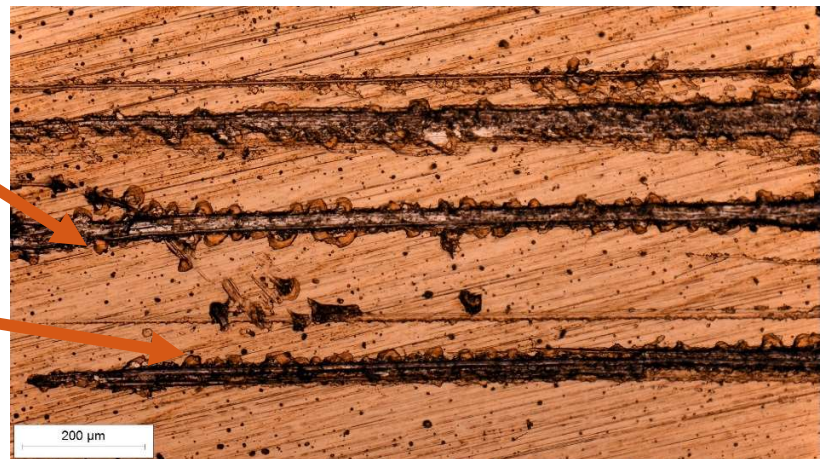
Slika 10.25. Alatni čelik K110 oznake D3 (TiN/TiBN prevlaka) na povećanju 50 puta
