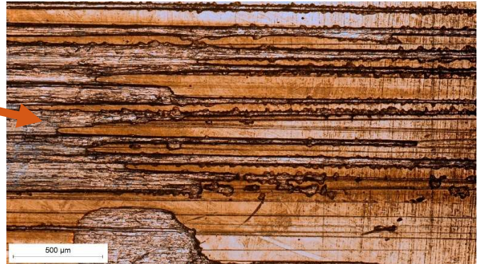
Slika 10.22. Alatni čelik K110 oznake D2 (TiN/TiCN prevlaka) na povećanju 50 puta
