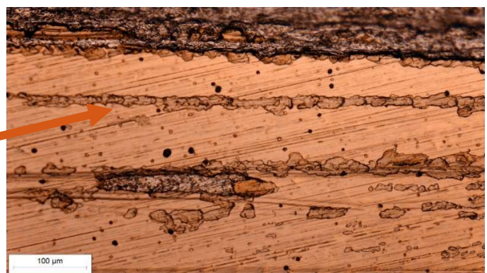
Slika 10.26. Alatni čelik K110 oznake D3 (TiN/TiBN prevlaka) na povećanju 100 puta
