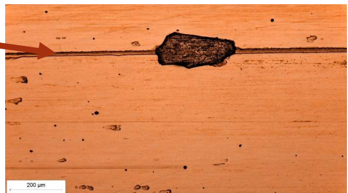
Slika 10.16. Alatni čelik K390 MC oznake C3 (TiN/TiBN prevlaka) na povećanju 50 puta
