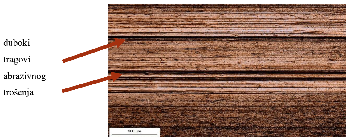
Slika 10.10. Alatni čelik K390 MC oznake C1 (plazma nitiranje) na povećanju 50 puta
