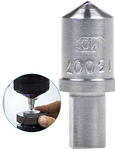
Slika 7.1. Dijamanti stožasti indentor [17]
