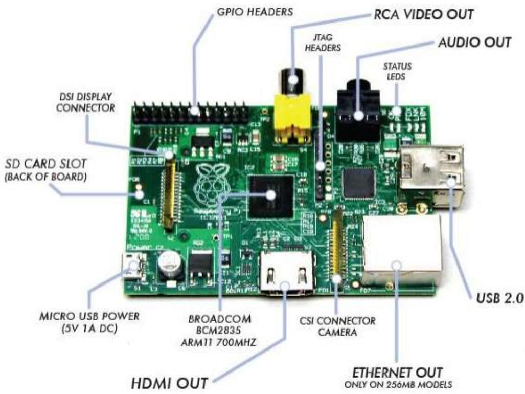
Slika 13. Struktura Raspberry Pi 2 računala
