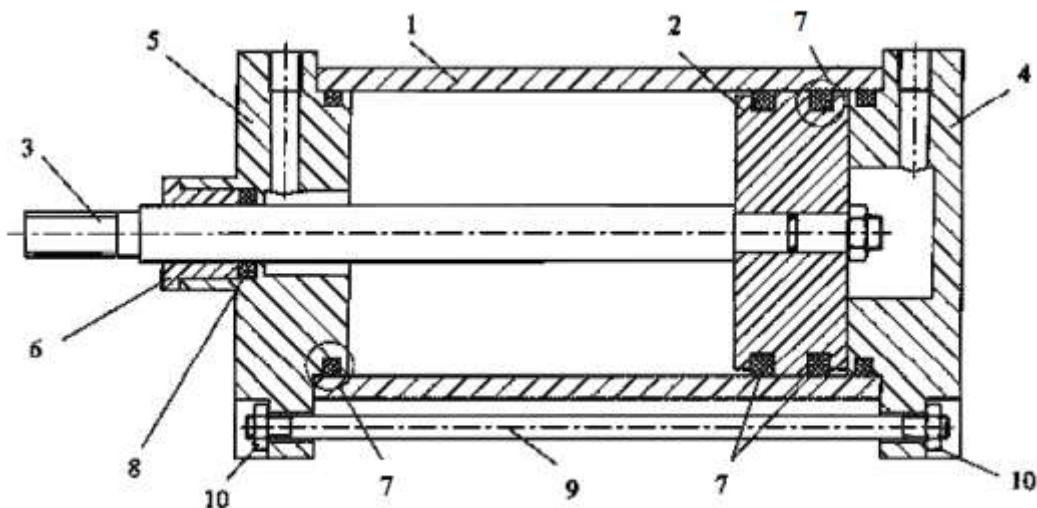
Dvoradni klipni cilindar      1 – cilindar, 2 – klip, 3 – klipnjača, 4 – prednji poklopac, 5 – stražnji poklopac, 6 – očnica, 7-8 – brtve, 9 – šipka, 10 - matica
