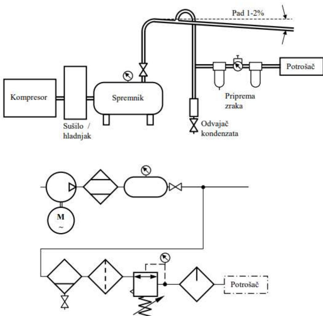
Slika 1. Skica i pneumatska shema sustava dobave zraka
