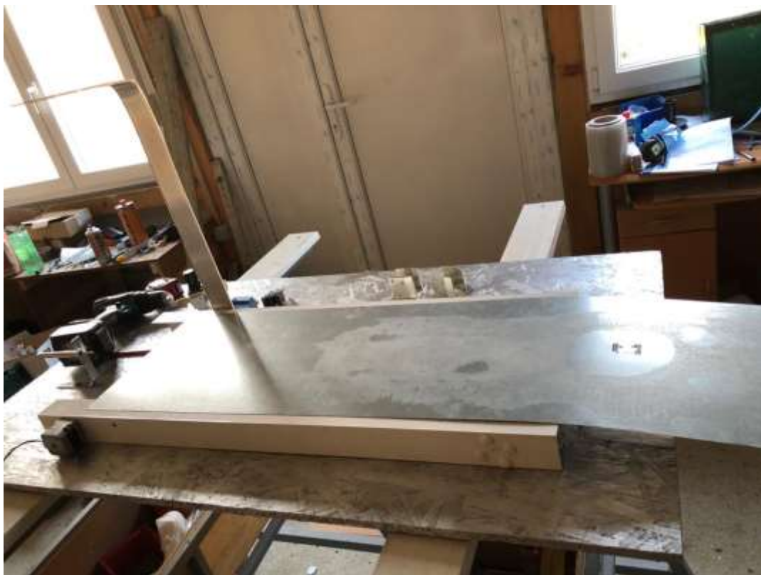
Slika 19. Postavljanje lima na stupove
