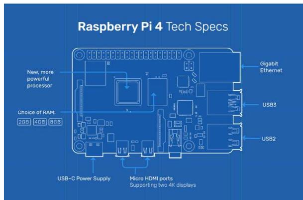
Slika 14: Prikaz I/O priključaka na Raspberry Pi 4
