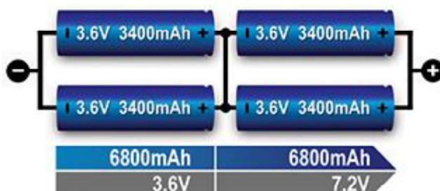
Slika 14 Serijski i paralelni spoj [4]
