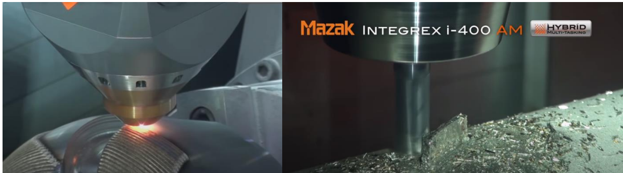
Slika 23. Obrada Integrex i-400 AM [22]
