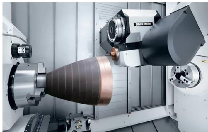
Slika 18. Obrada mlaznice rakete [19]
