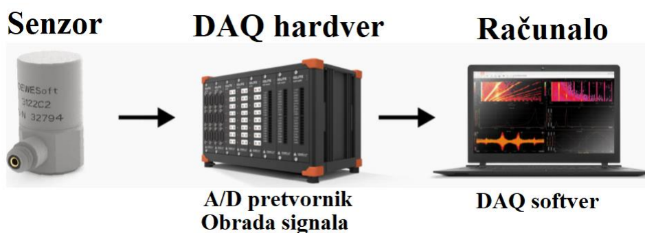
Slika 27. Princip rada sustava za prikupljanje i obradu podataka [23]
