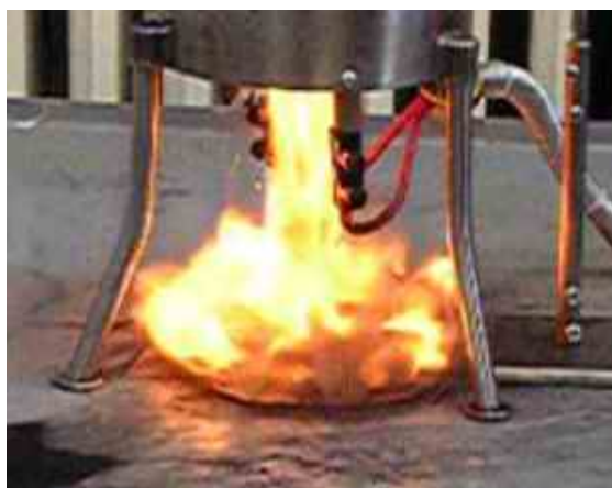
Slika 2.6 Izlaz plamena tijekom zapaljenja oblaka prašine [12]
