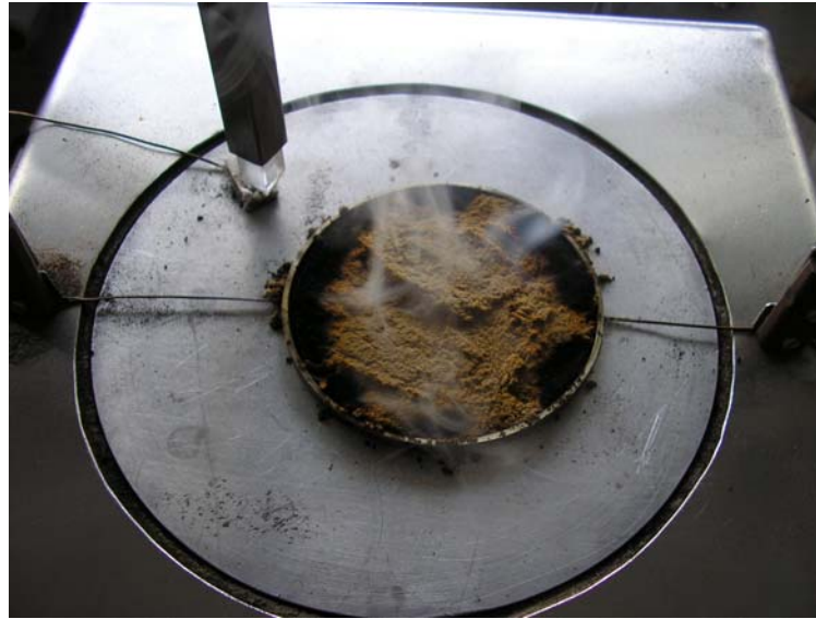
Slika 2.2 Početak tinjanja drvene prašine [12]
