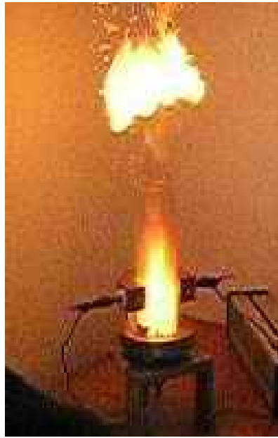
Slika 2.8 Zapaljeni uzorak prašine tijekom ispitivanja [12]
