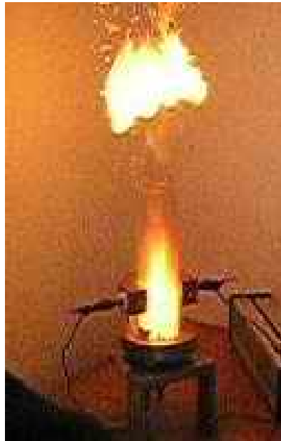
Slika 2.8 Zapaljeni uzorak prašine tijekom ispitivanja [12]
