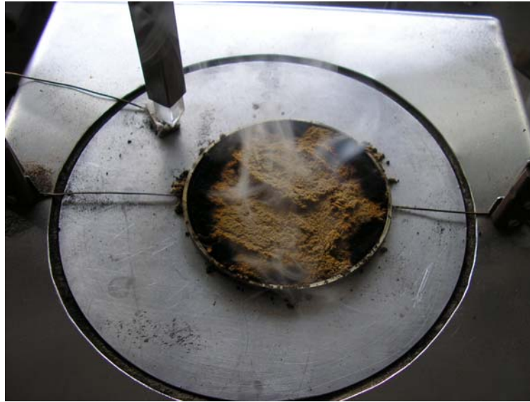
Slika 2.2 Početak tinjanja drvene prašine [12]
