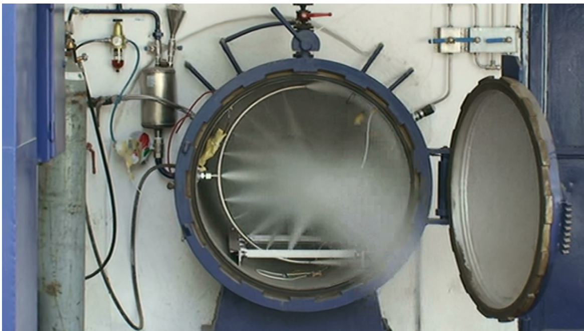
Slika 2.13 Potpuno raspršivanje uzorka prašine u kotlu volumena 1 m 3 [12]
