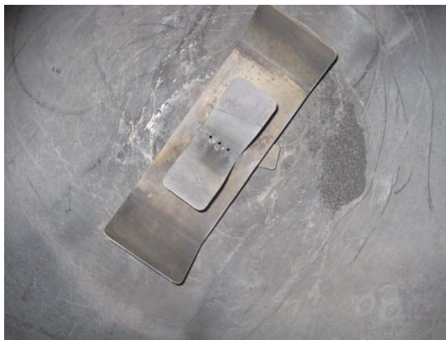
Slika 4.13 Mlaznica za raspršivanje uzorka prašine unutar ispitne komore
