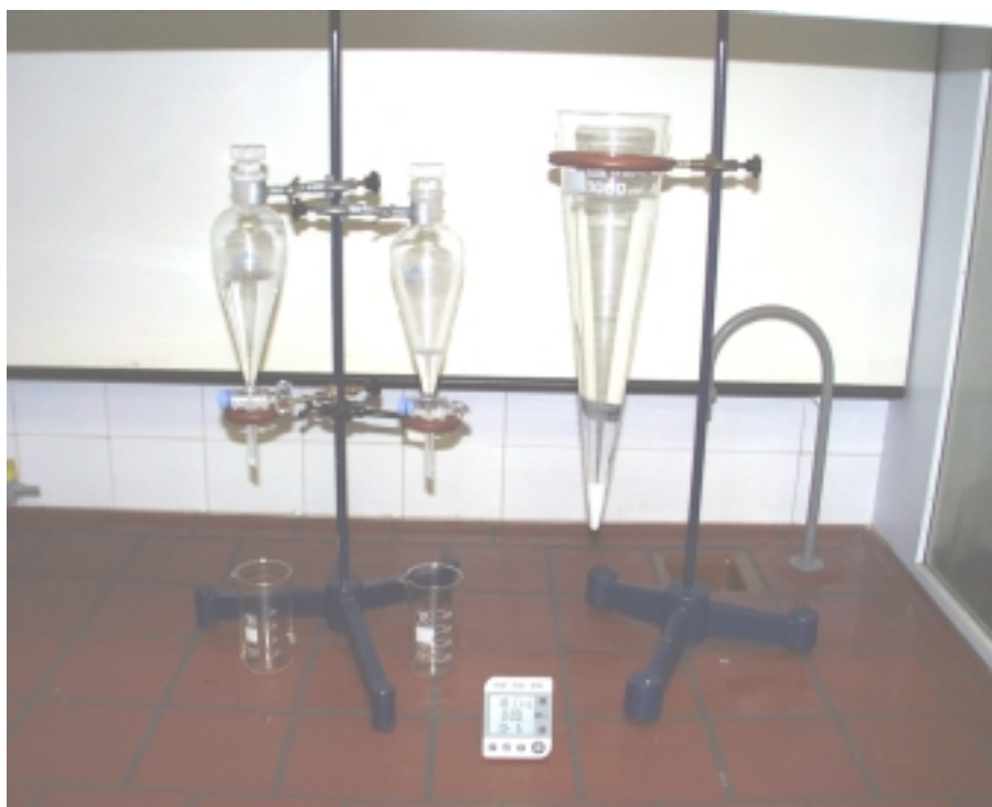
Slika 120. Prikaz pokusa taloženja \text{TiO}_2 . Na lijevom nosaču su dva odjelna lijevka od 250 ml, za rutil i anatas \text{TiO}_2 . Desno je Imhoff-ova posuda od 1 L.
