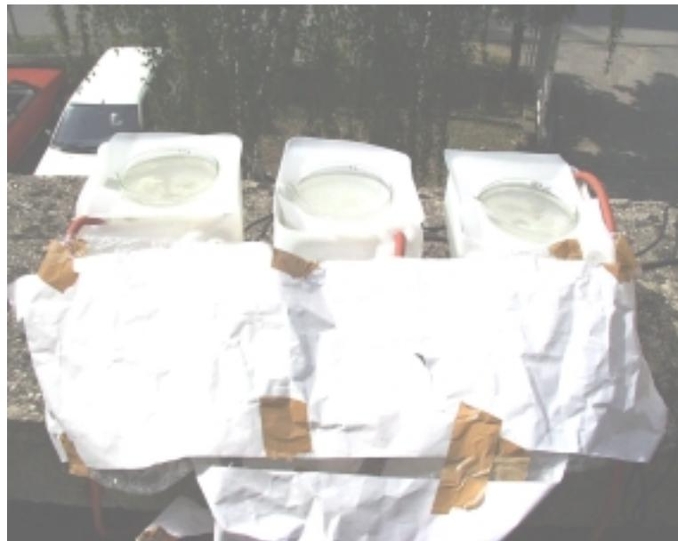
*Slika 15.* Fotografija detalja eksperimentalnog sustava za vrijeme odvijanja eksperimenta – reaktori s termostatirajućim posudama
