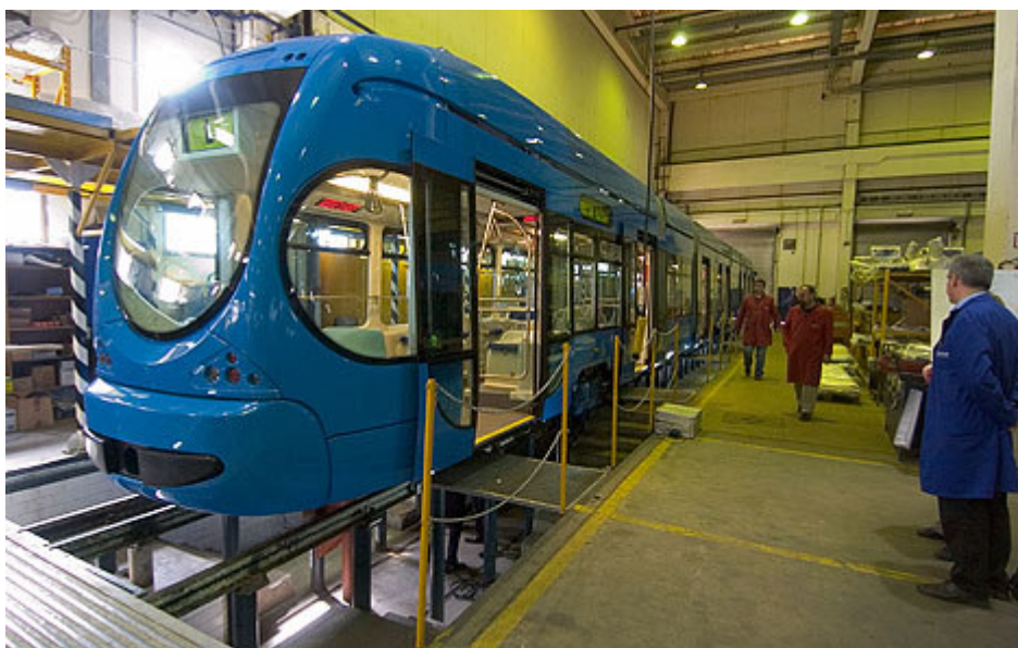
Slika 19: Konstrukcija tramvaja prije ugradnje ostalih komponenata [20]
