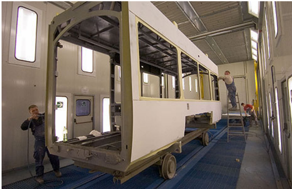
Slika 21: Zaštita i lakiranje tramvaja [20]
