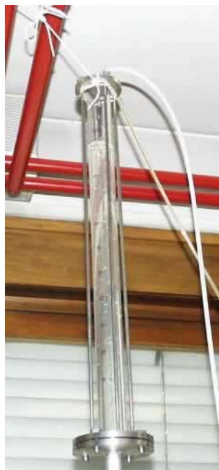
Slika 24. Fotografija staklenog vršnog dijela reaktora za ozonizaciju
