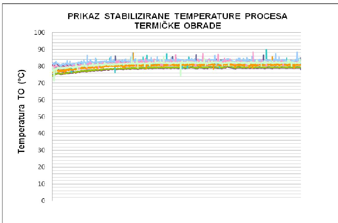
**SLIKA 28 :** Prikaz stabilizirane temperature procesa termičke obrade ( $T_{TO}$ ) s odstupanjem vrijednosti temperature ( $T_{TO}$ ) od  $+/- 0,5 ^\circ C$ .
