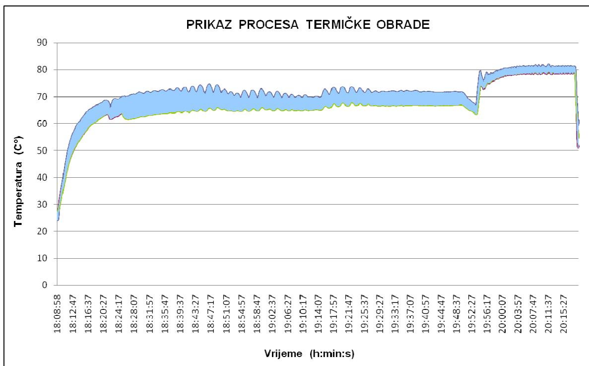
**SLIKA 25 :** Prikaz procesa termičke obrade proizvoda "Kranjska kobasica  $\Phi 32\text{ mm}$ "
