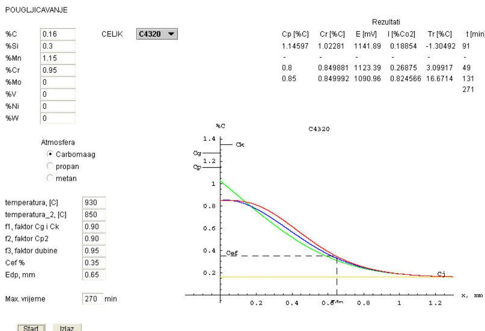
Slika 65. Završni ekran simuliranja postupka pougljičavanja u vlastitom računalskom programu, uzorak D, Č4320,  $Cp_1=1,15$ ,  $Cp_2=0,8$ ,  $Cp_3=0,85$ ,  $T_1=930 \text{ }^{\circ}\text{C}$ ,  $T_2=850 \text{ }^{\circ}\text{C}$ ,  $Edp = 0,65 \text{ mm}$ , zadani  $C_R = 0,8-0,85$
