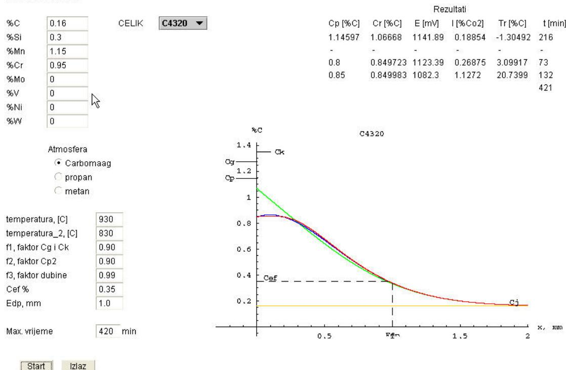
Slika 44. Pougljičavanje Č4320 , uz  $f_1=0,9$ ,  $f_2=0,9$ ,  $f_3=0,99$ ,  $Edp=1,00$ , uz trajanje procesa od 420 minuta
