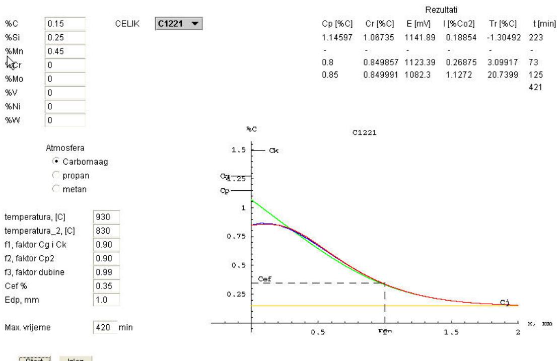
Slika 43. Pougljičavanje Č1221 , uz  $f_1=0,9$ ,  $f_2=0,9$ ,  $f_3=0,99$ ,  $Edp=1,00$ , uz trajanje procesa od 420 minuta
