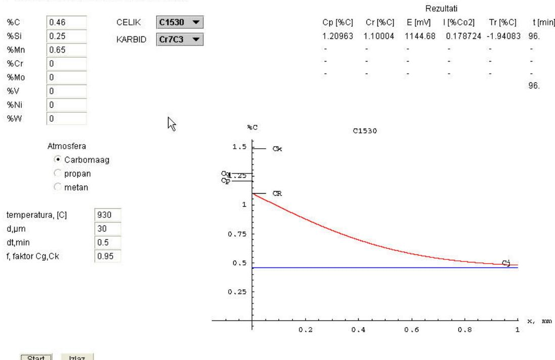
Slika 31. Pougličavanje prije stvaranja karbida Cr<sub>7</sub>C<sub>3</sub> na Č1530, debljine 30  $\mu\text{m}$ , na temperaturi 930 °C, uz f = 0,95
