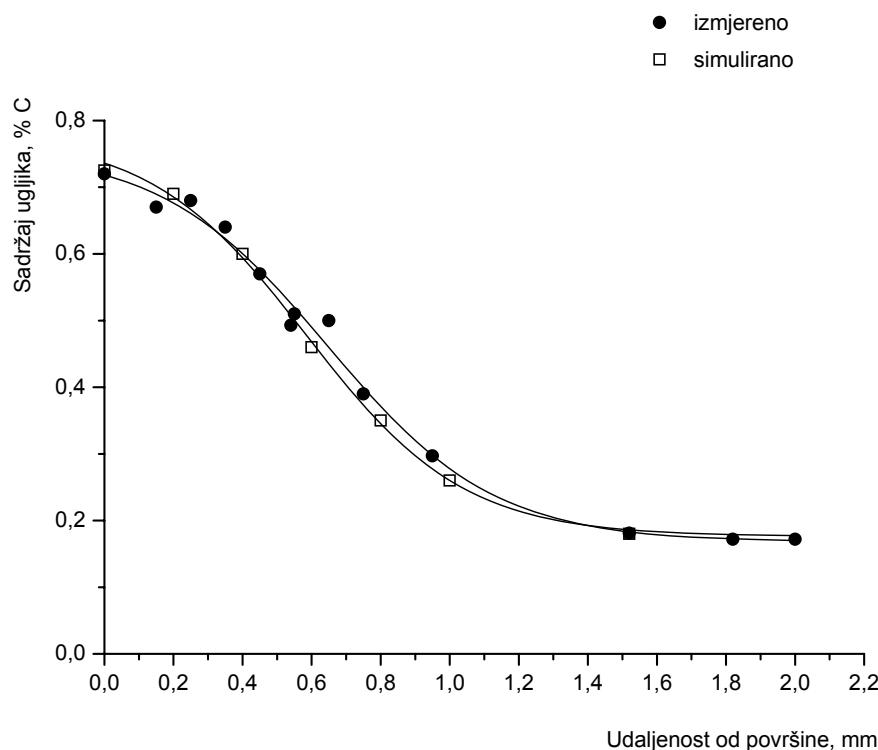
Slika 80. Usporedbeni prikaz izmijerenog toka ugljika i toka ugljika dobivenog simuliranjem postupka pougljičavanja u vlastitom računalskom programu, uzorak F, Č5421, na  $Edp=0,80$  mm,  $Cp_1=1,10$ ,  $Cp_2=0,70$ ,  $T_1=930$  °C,  $T_2=845$  °C, uz zadani  $C_R= 0,75-0,80$ , trajanje postupka 300 minuta
