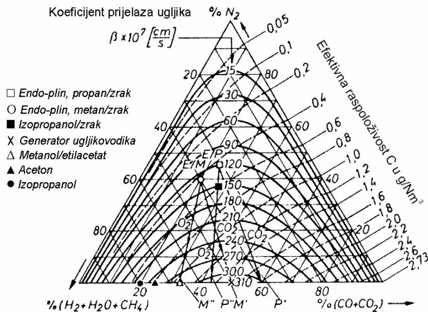
Slika 13. Prikaz koeficijenta difuzije,  $\beta$  (K) u sustavu  $(CO+CO_2)$  -  $(H_2+H_2O+CH_4)$  -  $N_2$ , kod  $900\text{ }^\circ\text{C}$  [9]
