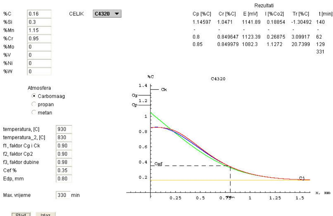
Slika 41. Pougljičavanje Č4320 , uz  $f_1=0,9$ ,  $f_2=0,9$ ,  $f_3=0,98$ ,  $Edp=0,80$ , uz trajanje procesa od 330 minuta
