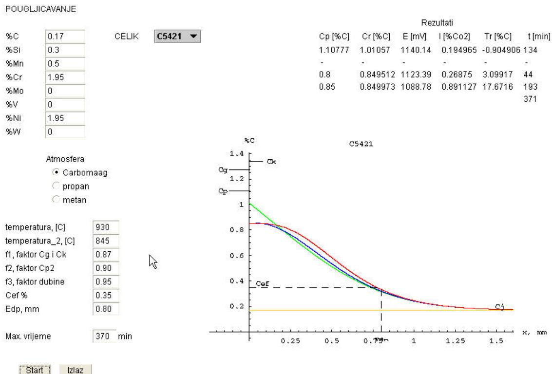
Slika 77. Završni ekran simuliranja postupka pougljičavanja u vlastitom računalskom programu, uzorak F, Č5421, na  $Edp = 0,80$  mm,  $Cp_1=1,10$ ,  $Cp_2=0,80$ ,  $Cp_3=0,85$ ,  $T_1=930$  °C,  $T_2=845$  °C, trajanje postupka 370 minuta
