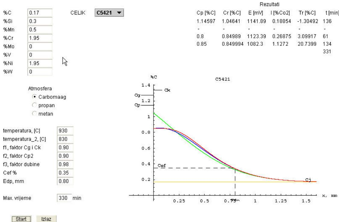
Slika 42. Pougljičavanje Č5421 , uz  $f_1=0,9$ ,  $f_2=0,9$ ,  $f_3=0,98$ ,  $Edp=0,80$ , uz trajanje procesa od 330 minuta
