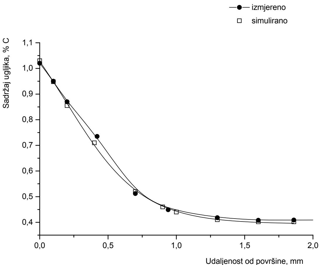
Slika 51. Usporedbeni prikaz izmijerenog toka ugljika i toka ugljika dobivenog simuliranjem postupka pougljičavanja u vlastitom računalskom programu, uzorak B, Č 4751,  $C_p = 1,10$ ,  $T_1 = 930 \text{ } ^\circ\text{C}$ ,  $T_2 = 845 \text{ } ^\circ\text{C}$
