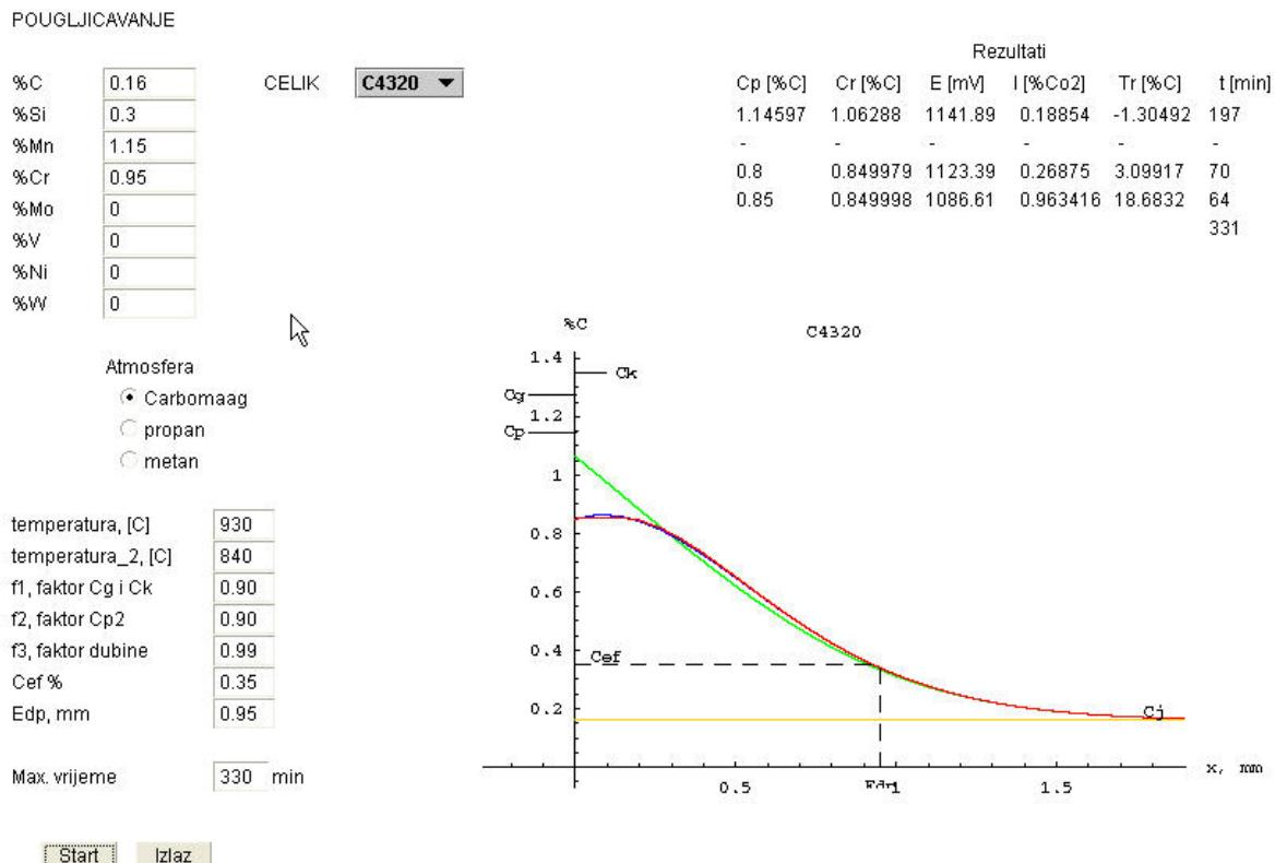
Slika 73. Završni ekran simuliranja postupka pougljičavanja u vlastitom računalskom programu, uzorak E, Č4320,  $Edp = 0,95$  mm,  $T_1=930$  °C,  $T_2=840$  °C,  $Cp_1=1,15$ ,  $Cp_2=0,80$ ,  $Cp_3=0,85$ , uz zadani  $C_R=0,80-0,85$ , trajanje procesa 330 min.
