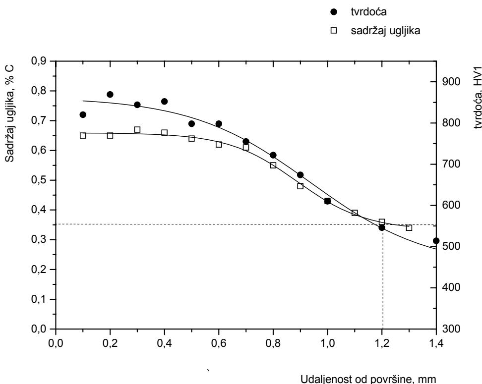
Slika 56. Dijagram izmjerene tvrdoće i sadržaja ugljika, uzorak C, Č4320
