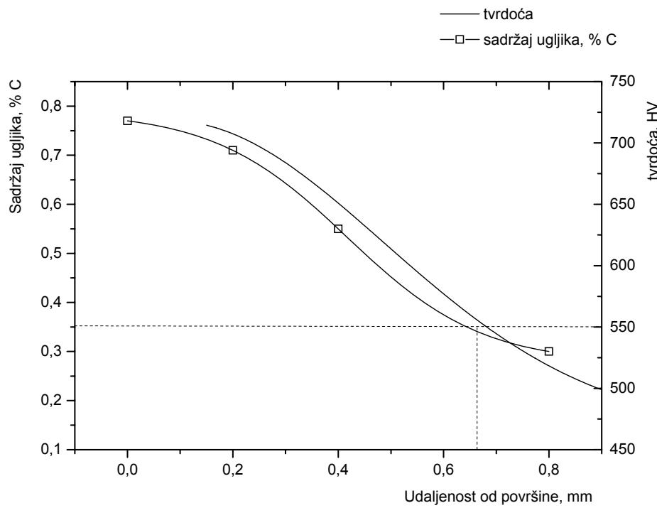
Slika 64. Dijagram izmjerenoj toke mikrotvrdoće i sadržaja ugljika, uzorak D, Č4320
