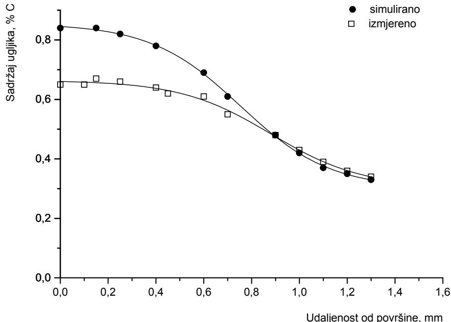
Slika 58. Usporedbeni prikaz izmjerenog toka ugljika i toka ugljika dobivenog simuliranjem postupka pougljičavanja u vlastitom računalskom programu, uzorak C, Č4320
