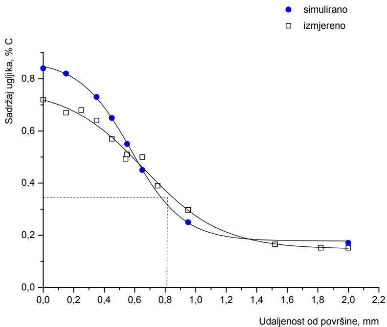
Slika 78. Usporedbeni prikaz izmjereno i toku ugljika dobivenog simuliranjem postupka pougljičavanja u vlastitom računalskom programu, uzorak F, Č5421, na  $Edp=0,80$  mm
