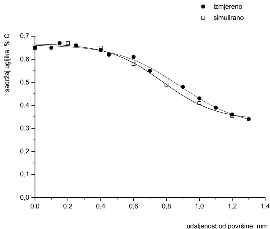
Slika 61. Usporedbeni prikaz izmijerenog toka ugljika i toka ugljika dobivenog simuliranjem postupka pougljičavanja u vlastitom računalskom programu, uzorak C, Č4320, na  $Edp=1,20$  mm, uz  $Cp_1=1,10$ ,  $Cp_2=0,60$ ,  $T_1=930$   $^{\circ}\text{C}$ ,  $T_1=850$   $^{\circ}\text{C}$ , uz  $C_R=0,60-0,65$ .
