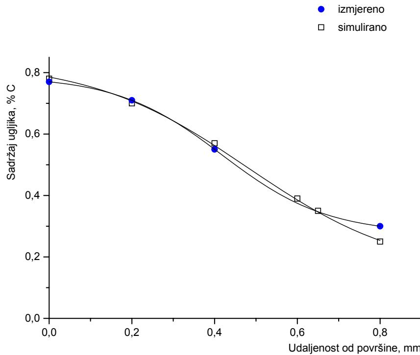
Slika 69. Usporedbeni prikaz izmijerenog toka ugljika i toka ugljika dobivenog simuliranjem postupka pougljičavanja u vlastitom računalskom programu, D, Č4320,  $C_{p1}=1,15$ ,  $C_{p2}=0,75$ ,  $T_1=930^{\circ}\text{C}$ ,  $T_2=850^{\circ}\text{C}$ ,  $Edp = 0,65 \text{ mm}$ , uz  $C_R = 0,75-0,80$
