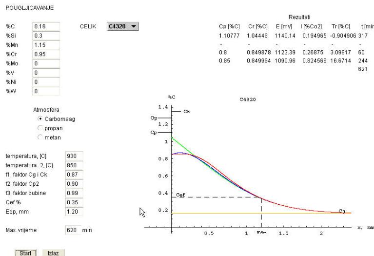
Slika 57. Završni ekran simuliranja postupka pougljičavanja u vlastitom računalskom paketu, uzorak C, Č4320, na  $Edp=1,20$  mm,  $Cp_1=1,10$ ,  $Cp_2=0,80$ ,  $Cp_3=0,85$ , uz zadani  $C_R=0,80-0,85$ , trajanje postupka 620 minuta.
