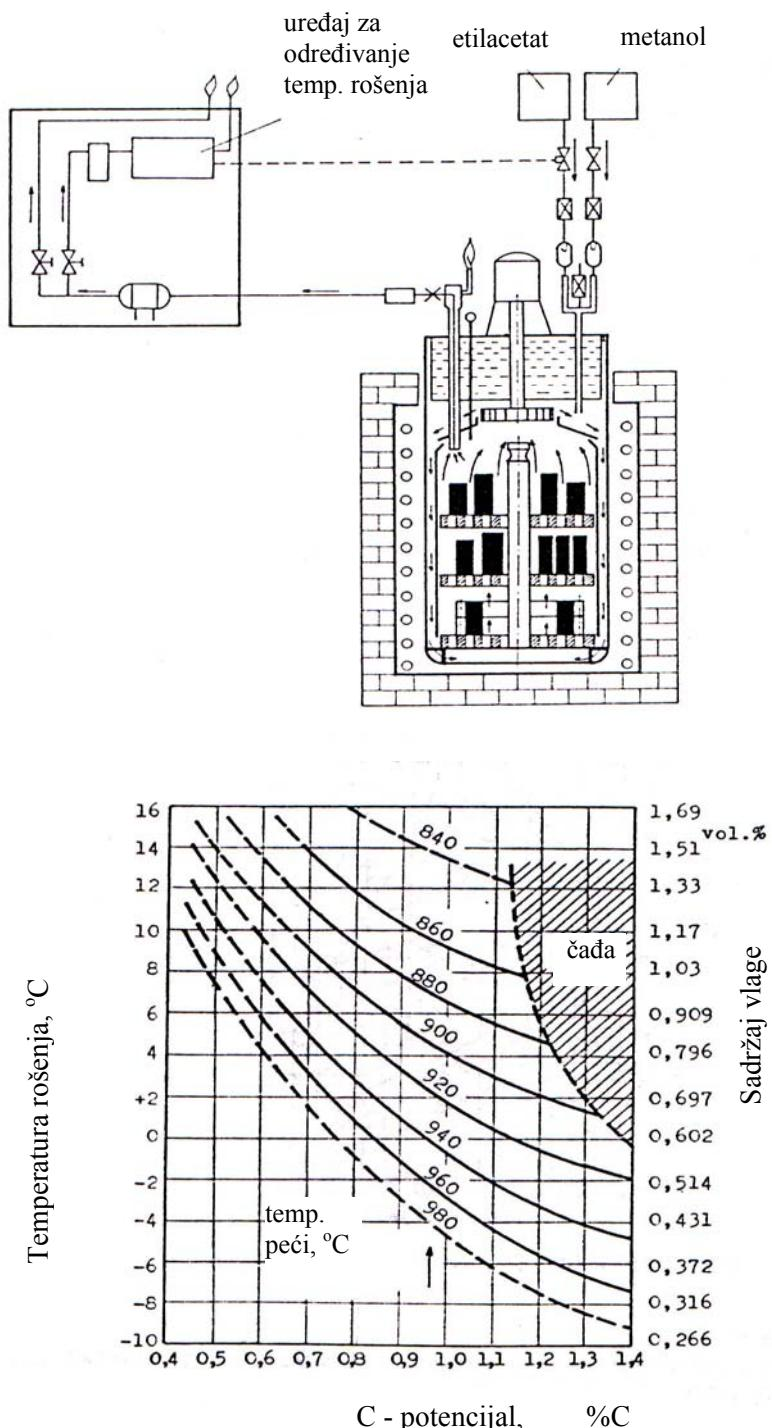
Slika 23. Shema mjerjenja i reguliranja C-potencijala na osnovi mjerjenja temperature rošenja u plinskoj atmosferi metanol / etilacetat [12]
