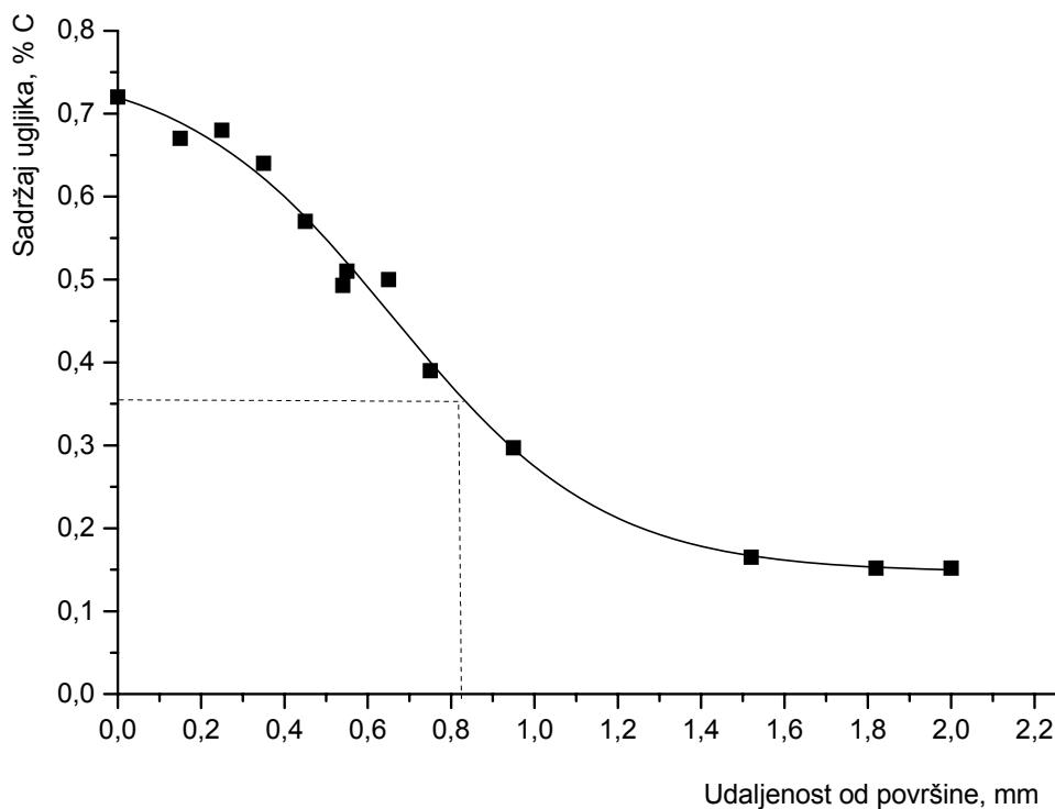
Slika 76. Dijagram izmјerenog toka ugljika u ovisnosti od udaljenosti od površine, uzorak F, Č5421
