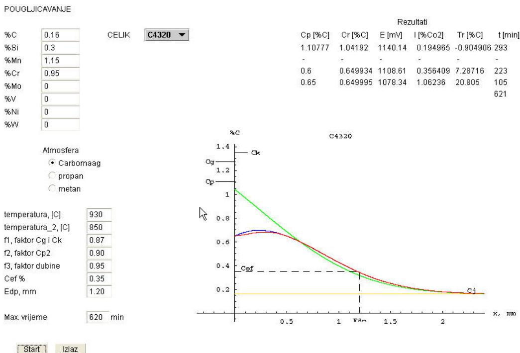
Slika 60. Završni ekran simuliranja postupka pougljičavanja u vlastitom računalskom paketu, uzorak C, Č4320, na  $Edp=1,20$  mm, uz  $Cp_1=1,10$ ,  $Cp_2=0,60$ ,  $Cr_2=0,65$ ,  $T_1=930$  °C,  $T_2=850$  °C uz  $C_R=0,60-0,65$ , trajanje postupka 620 minuta
