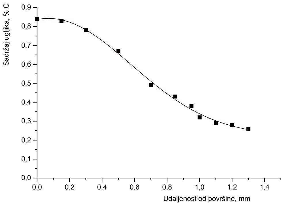
Slika 71. Dijagram izmјerenog toka ugljika u ovisnosti o udaljenosti od površine, uzorak E, Č4320
