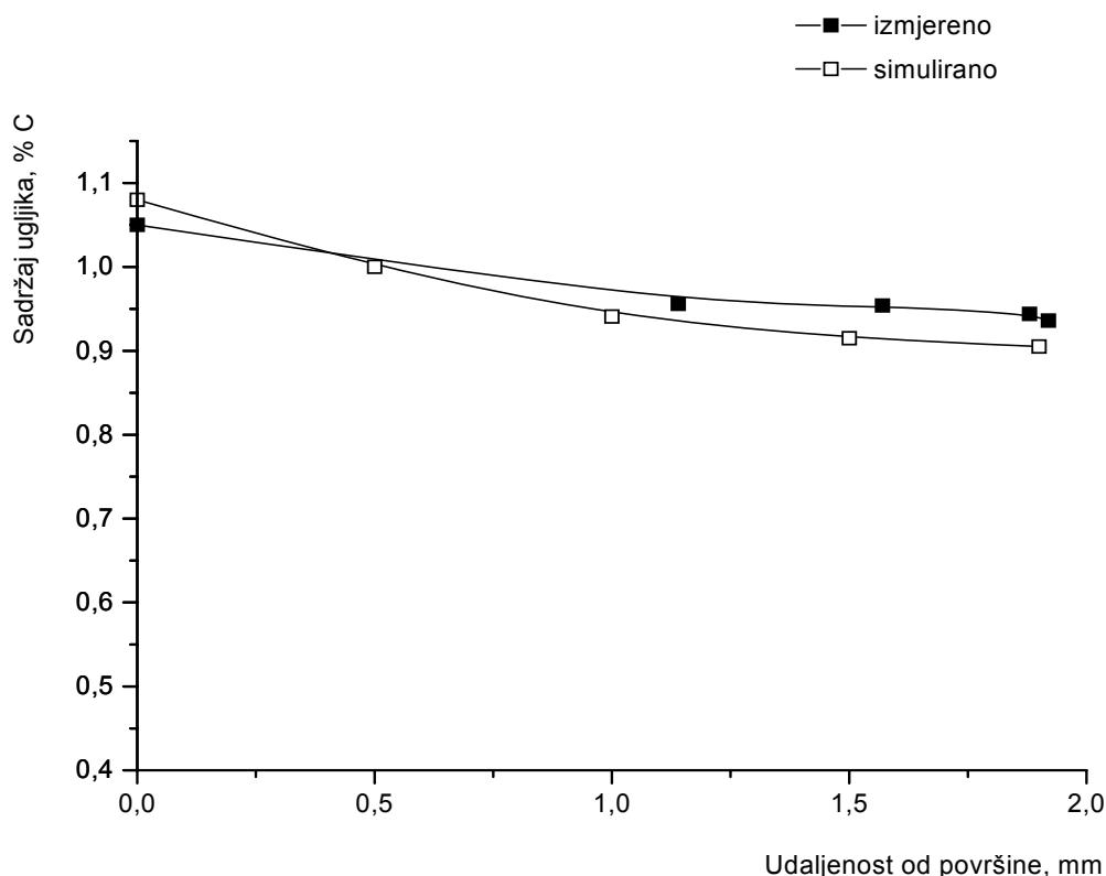
Slika 49. Usporedbeni prikaz izmjerenog toka ugljika i toka ugljika dobivenog simuliranjem postupka pougljičavanja u vlastitom računalskom programu, uzorak A, Č 3840,  $C_p = 1,10$ ,  $T_1 = 930 \text{ } ^\circ\text{C}$ ,  $T_2 = 845 \text{ } ^\circ\text{C}$
