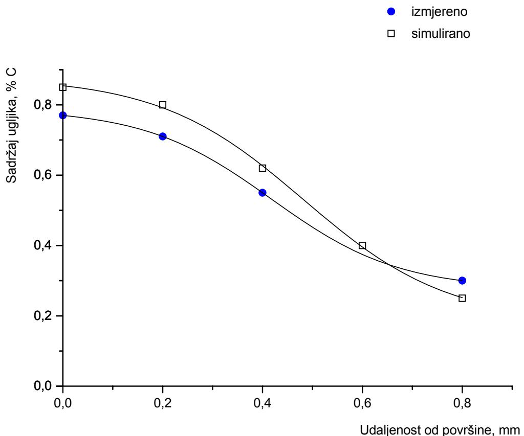
Slika 66. Usporedbeni prikaz izmjerenog toka ugljika i toka ugljika dobivenog simuliranjem postupka pougljičavanja u vlastitom računalskom programu, uzorak D, Č4320,  $Edp=0,65$ ,  $C_p=1,15$ ,  $T_1=930$  °C,  $T_2=850$  °C
