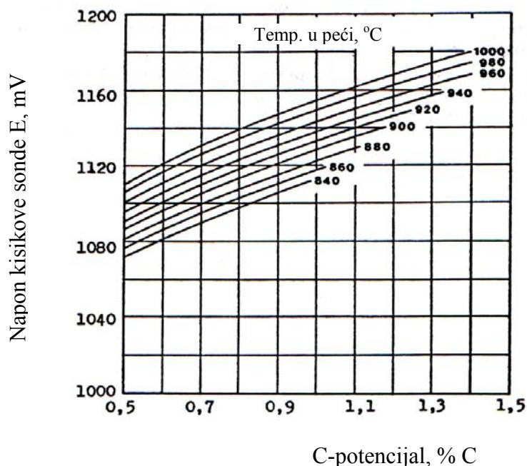
Slika 24. Shema mjerena i regulacije C-potencijala pomoću kisikove sonde [12]
