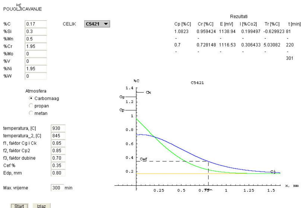
Slika 79. Završni ekran simuliranja postupka pougljičavanja u vlastitom računalskom programu, uzorak F, Č5421, na  $Edp = 0,80$  mm,  $Cp_1=1,10$ ,  $Cp_2=0,70$ ,  $T_1=930$  °C,  $T_2=845$  °C, uz zadani  $C_R=0,75-0,80$ , trajanje postupka 300 minuta
