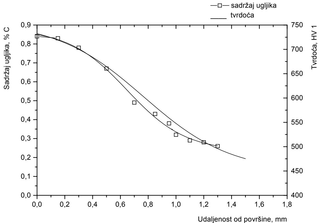
Slika 72. Dijagram izmјerenog toka mikrotvrdće i toka ugljika, uzorak E, Č4320
