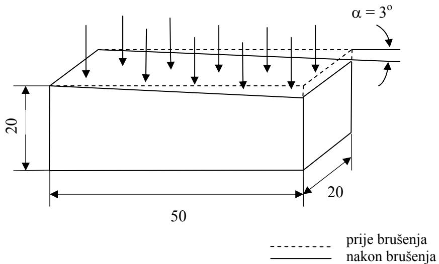
Slika 53. Uzorak za pougljičavanje u sklopu postupka cementiranja
