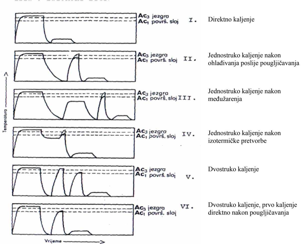
Slika 9. Vrste kaljenja nakon pougljičavanja [6]
