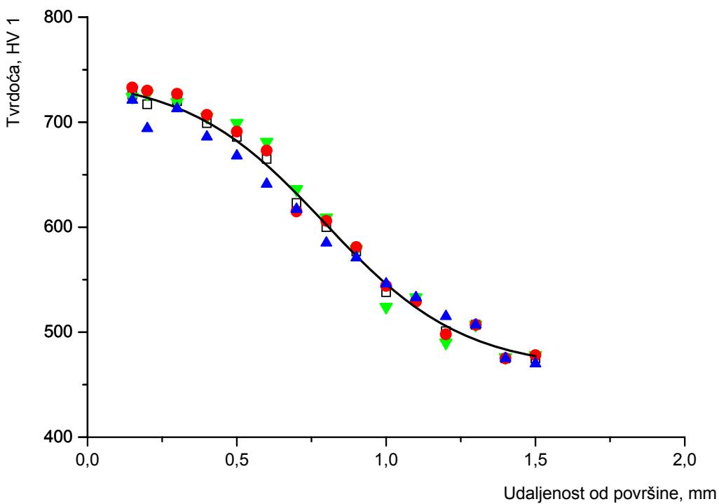
Slika 70. Dijagram toku mikrotvrdće u ovisnosti o udaljenosti od površine, uzorak E, Č4320
