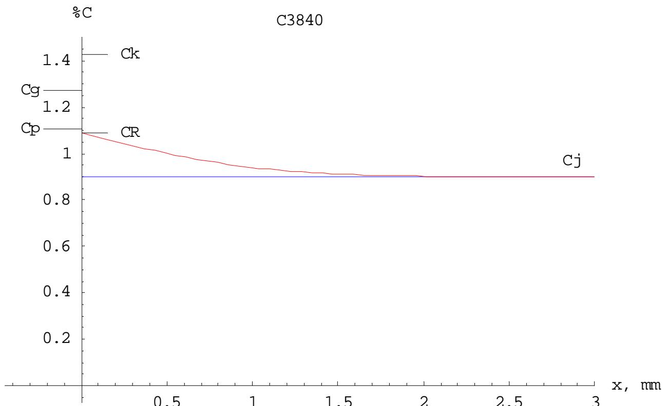
Slika 48. Dijagram toka ugljika u čeliku kod simulacija postupka pougljičavanja u vlastitom računalskom programu (dio za pougljičavanje prije stvaranja karbida), uzorak A, Č3840 uz  $C_{p1} = 1,10$ ,  $T_1 = 930$  °C,  $T_2 = 845$  °C
