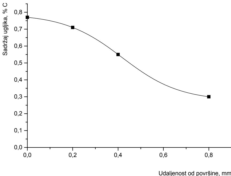
Slika 63. Dijagram izmjerenoj toka ugljika, uzorak D, Č4320
