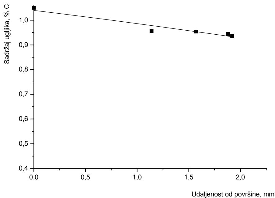
Slika 47. Prikaz izmјerenog toka ugljika nakon pougljičavanja, uzorak A, Č3840
