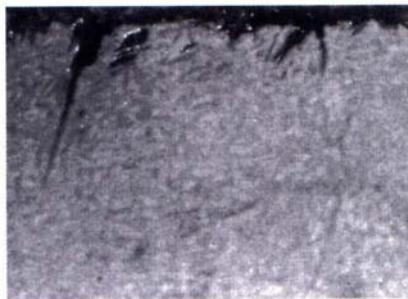
Slika 5. Mikrosnimka presjeka površine konvencionalno (plinski) pougljičenog sloja [ 5]
