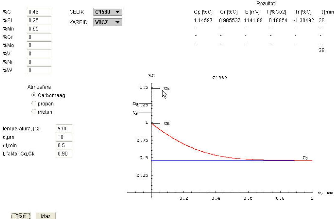
Slika 30. Pougličavanje prije stvaranja karbida V<sub>8</sub>C<sub>7</sub> na Č1530, debljine 10  $\mu\text{m}$ , na temperaturi 930 °C, uz f = 0,9
