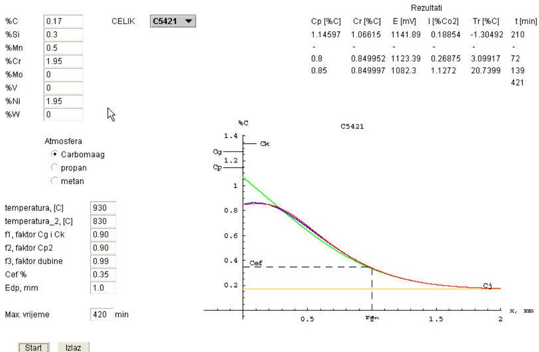
Slika 45. Pougljičavanje Č5421 , uz  $f_1=0,9$ ,  $f_2=0,9$ ,  $f_3=0,99$ ,  $Edp=1,00$ , uz trajanje procesa od 420 minuta
