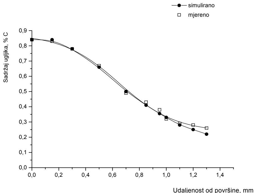
Slika 74. Usporedbeni prikaz izmjerenoj i toku ugljika dobivenog simuliranjem postupka pougljičavanja u vlastitom računalskom programu, uzorak E, Č4320,  $Edp=0,95$  mm
