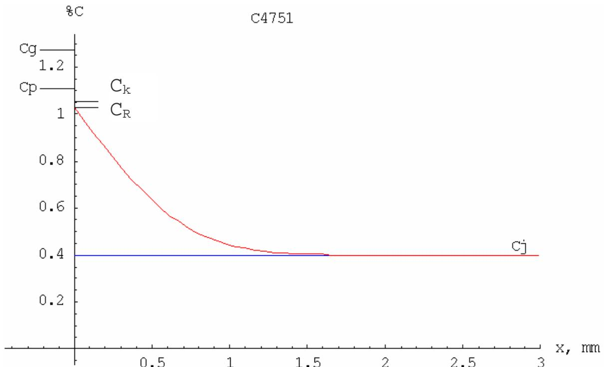
Slika 50. Dijagram toka ugljika u čeliku kod simulacije postupka pougljičavanja u vlastitom računalskom programu (dio za pougljičavanje prije stvaranja karbida), uzorak B, Č4751 uz  $C_p = 1,10$ ,  $T_1 = 930$  °C,  $T_2 = 845$  °C
