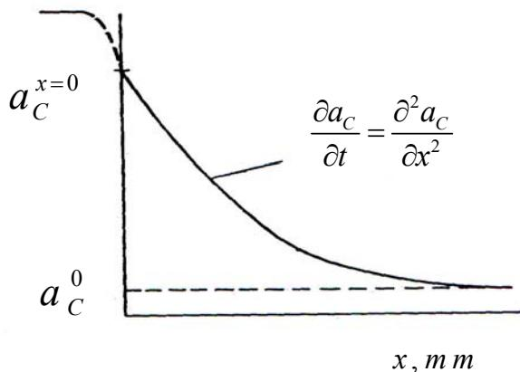
Slika 18. Dijagram uz novi model pougljičavanja čelika [8]
