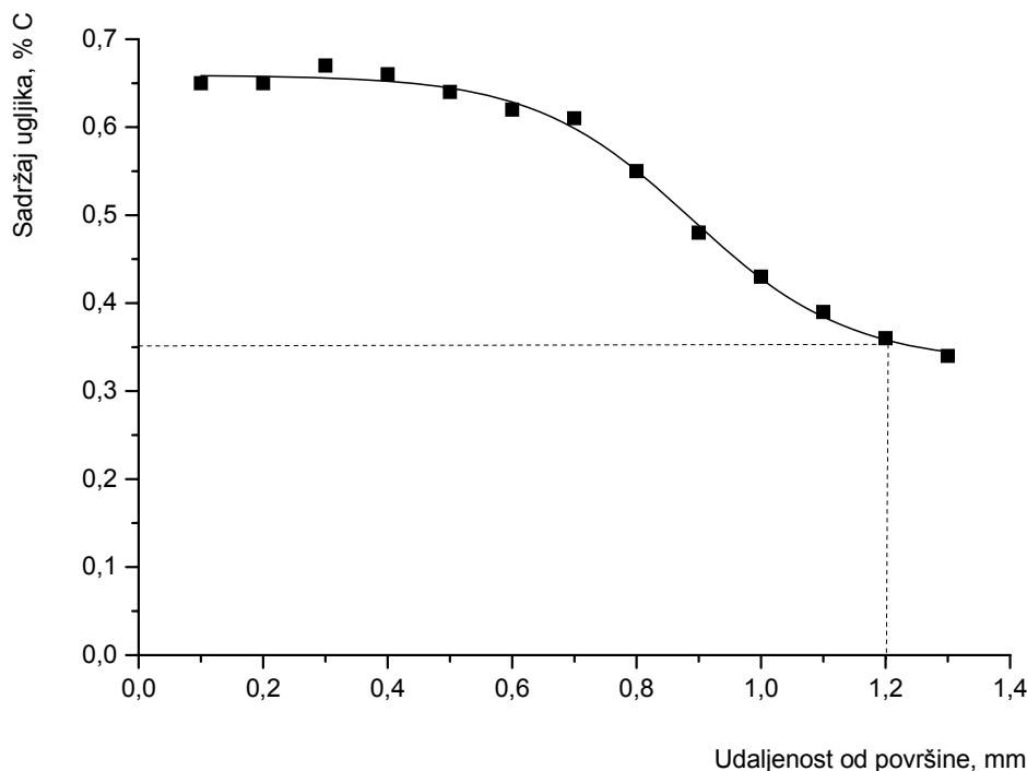
Slika 55. Dijagram izmjerenoj koncentracije ugljika, uzorak C, Č4320
