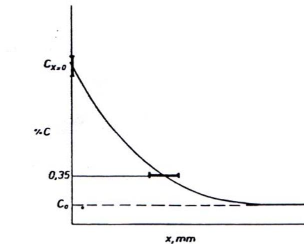
Slika 14. Shematski prikaz vrijednosti koje se zahtijevaju kod pougljičavanja čelika [8]
