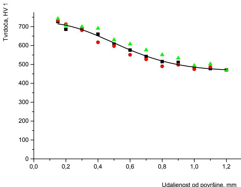
Slika 62. Dijagram izmjerenoj toki mikrotvrdoće u ovisnosti o udaljenosti od površine, uzorak D, Č4320
