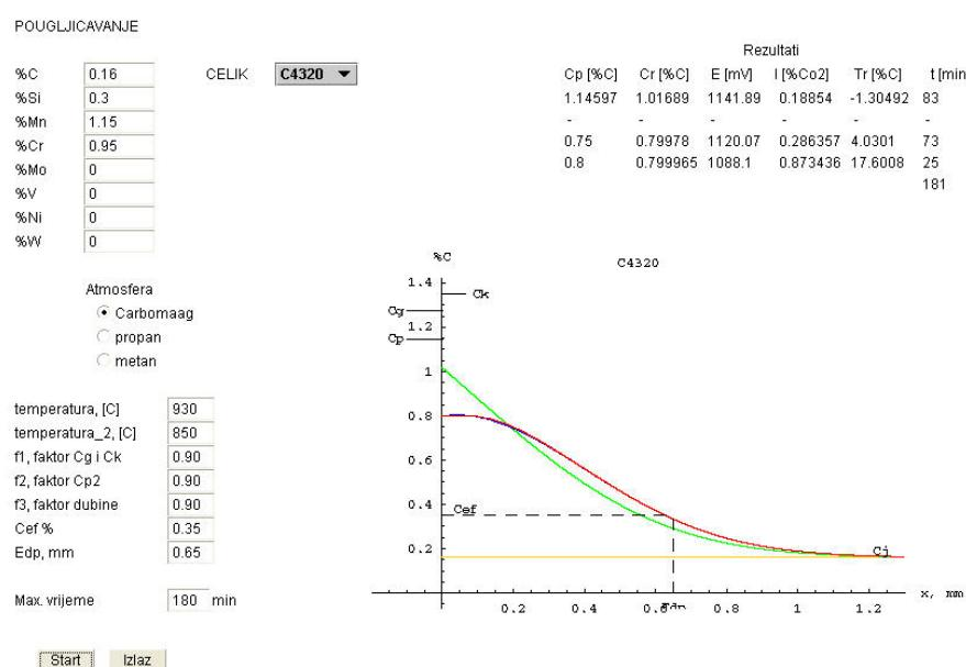
Slika 68. Završni ekran simuliranja postupka pougljičavanja u vlastitom računalskom programu, uzorak D, Č4320,  $C_p1=1,15$ ,  $C_p2=0,75$ ,  $C_p3=0,80$ ,  $T_1=930\text{ }^{\circ}\text{C}$ ,  $T_2=850\text{ }^{\circ}\text{C}$ ,  $Edp = 0,65\text{ mm.}$ , uz  $C_R=0,75-0,80$ , trajanje 180 minuta
