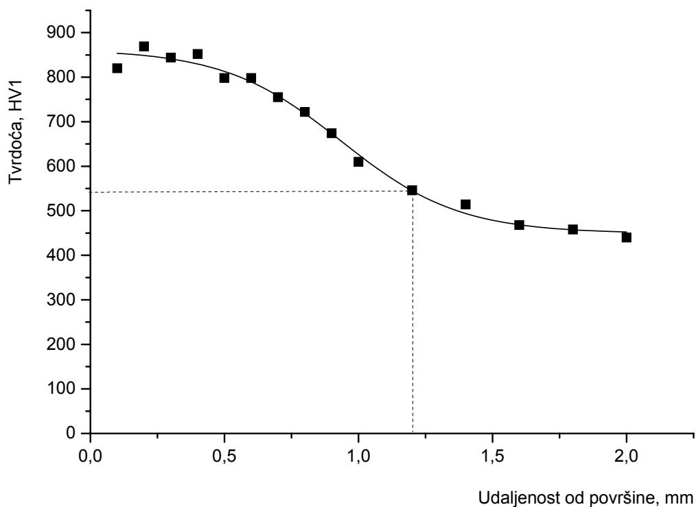
Slika 54. Dijagram izmjerenog toka tvrdoće, uzorak C, Č4320
