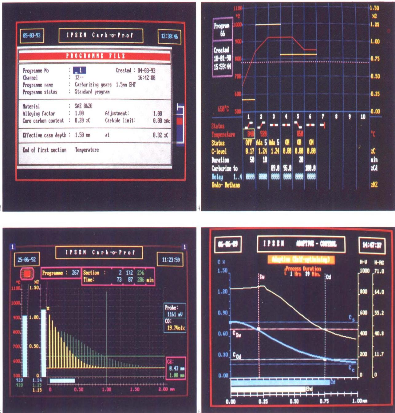
Prikaz ekrana računalskog paketa za simuliranje procesa pougljičavanja, Carb-o-Prof (Ipsen)
