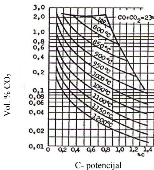
Slika 22. Primjer određivanja C-potencijala na temelju mjerena CO<sub>2</sub> [12]
