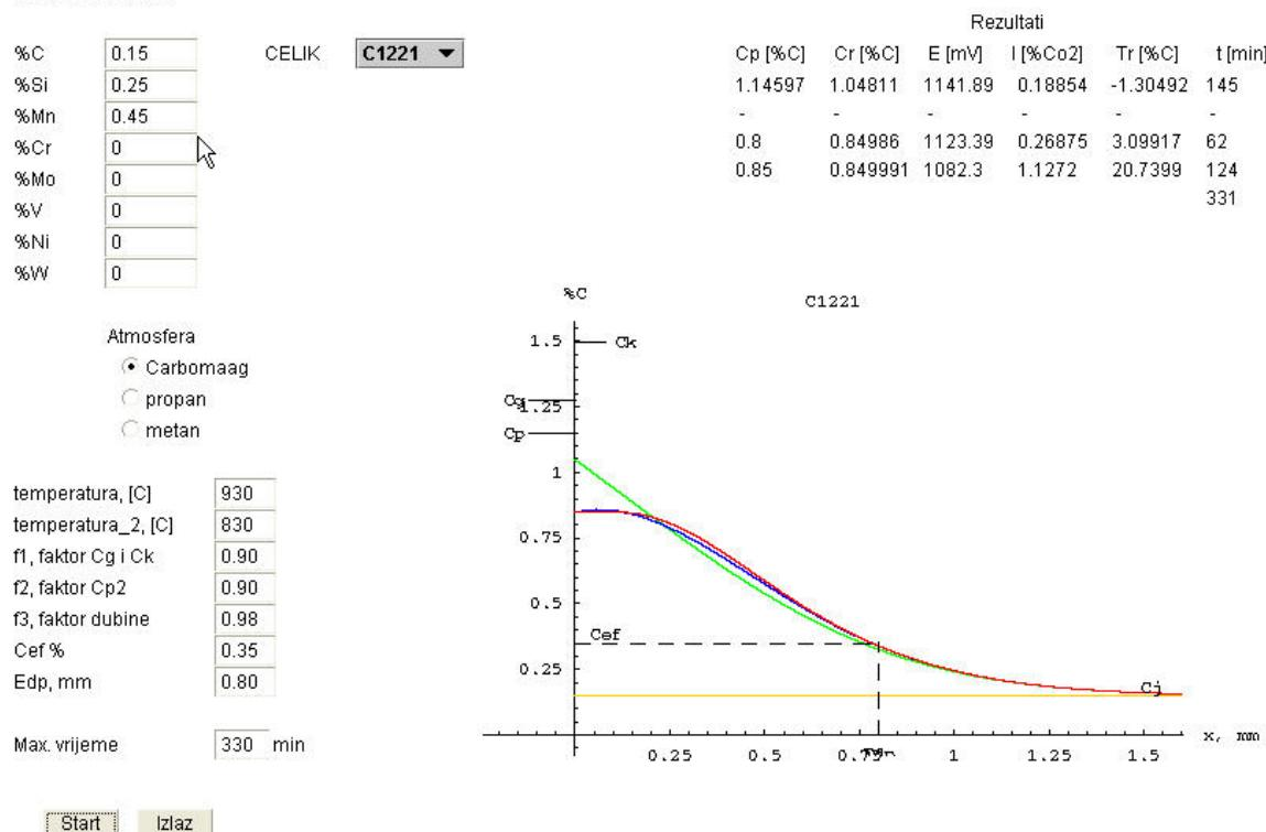
Slika 40. Pougljičavanje Č1221 , uz  $f_1=0,9$ ,  $f_2=0,9$ ,  $f_3=0,98$ ,  $Edp=0,80$ , uz trajanje procesa od 330 minuta
