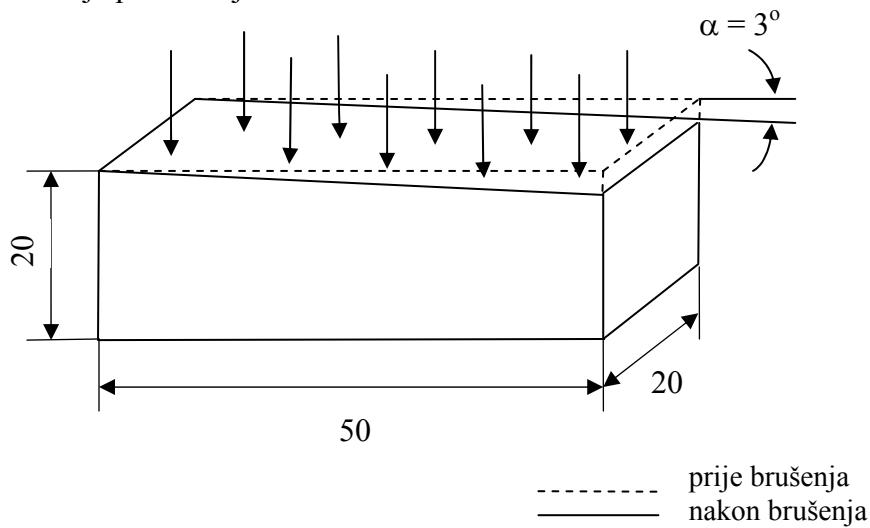
Slika 46. Uzorak za pougljičavanje prije stvaranja karbida
