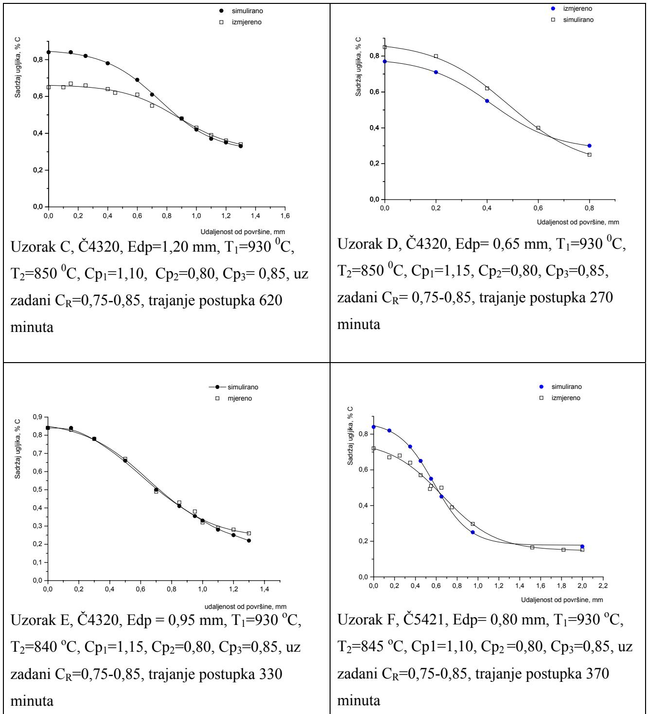
Slika 81. Prikaz izmjerenih i simuliranih tokova ugljika za uzorce C, D, E i F, uz zadani  $C_R = 0,75-0,85$
