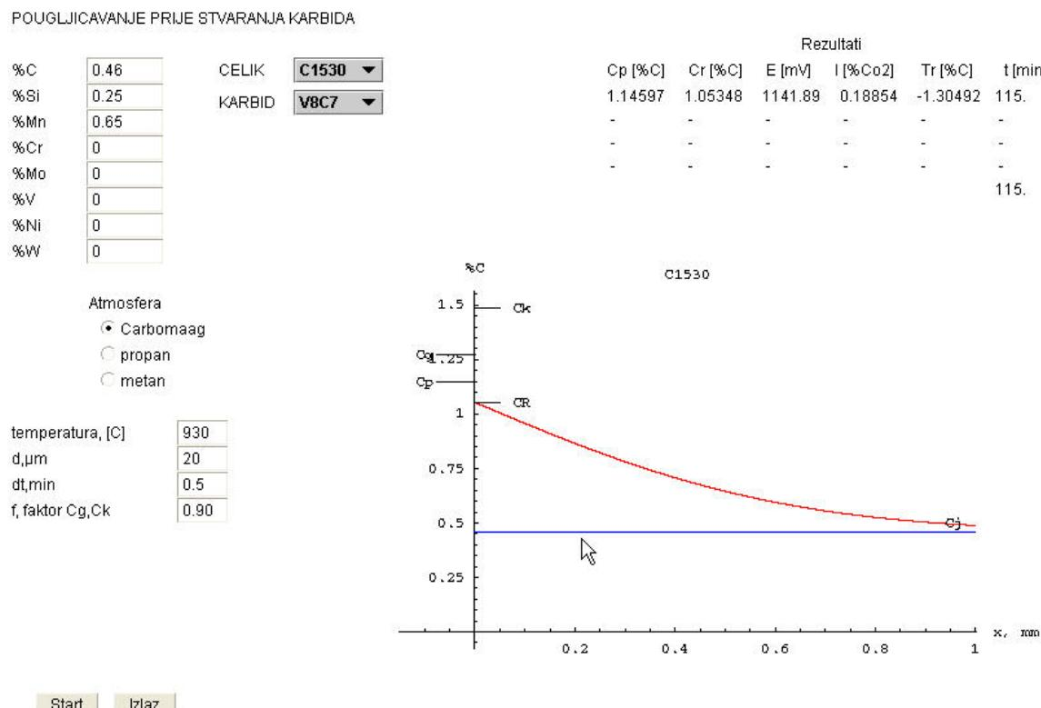
Slika 29. Pougljičavanje prije stvaranja karbida V<sub>8</sub>C<sub>7</sub> na Č1530, debljine 20 μm, na temperaturi 930 °C, uz f = 0,9
