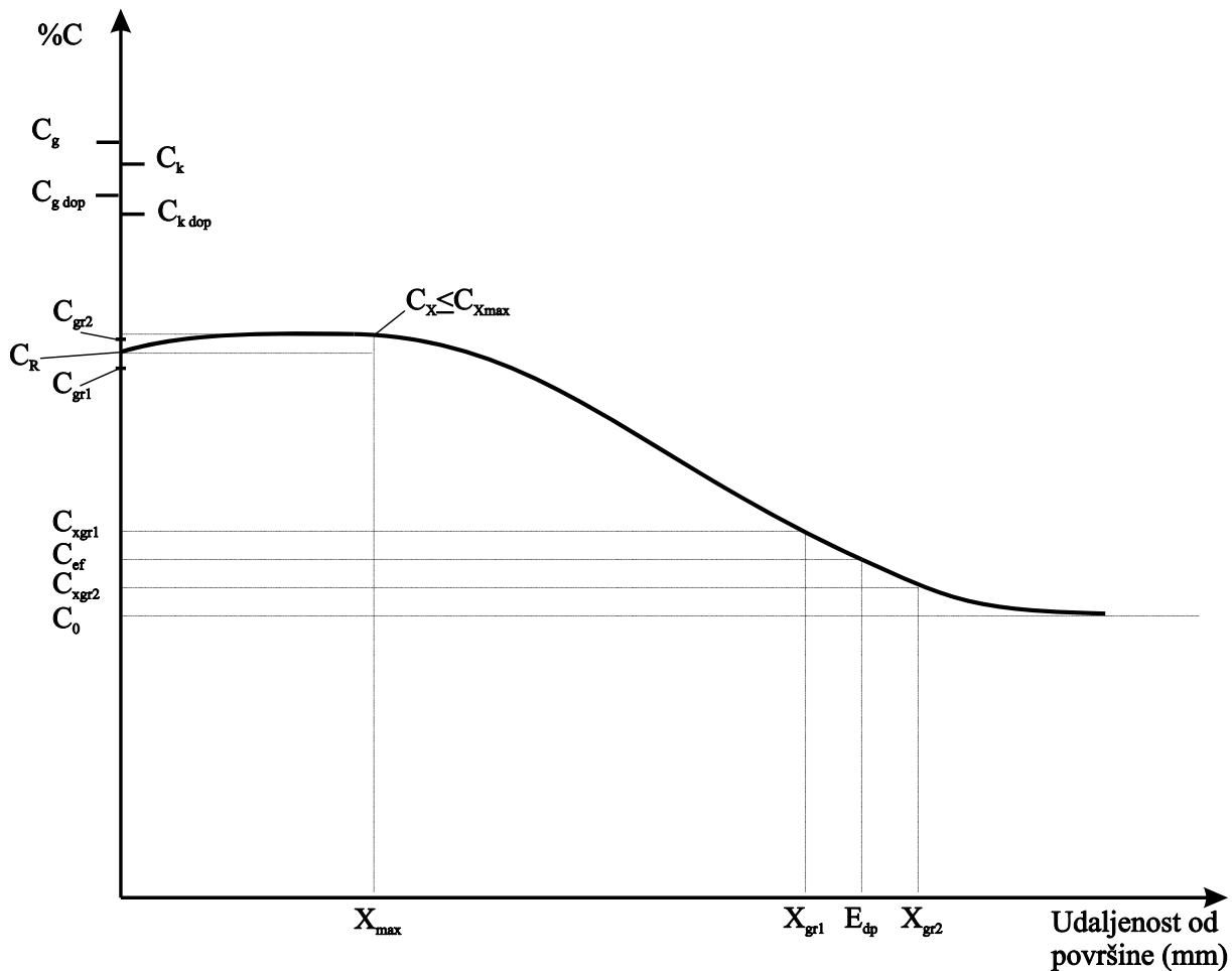
Slika 35. Završni profil sadržaja ugljika ovisno o udaljenosti od površine
