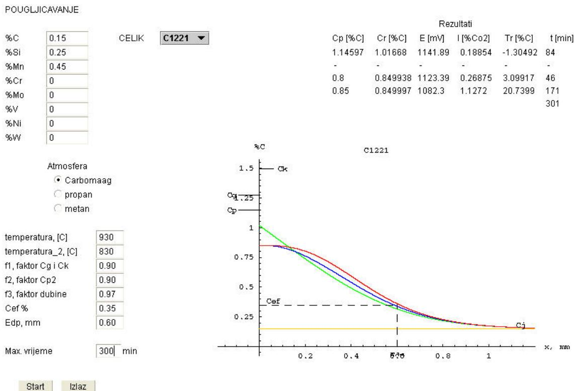
Slika 39. Pougljičavanje Č1221, uz  $f_1=0,9$ ,  $f_2=0,9$ ,  $f_3=0,97$ ,  $Edp=0,60$ , uz trajanje procesa od 300 minuta
