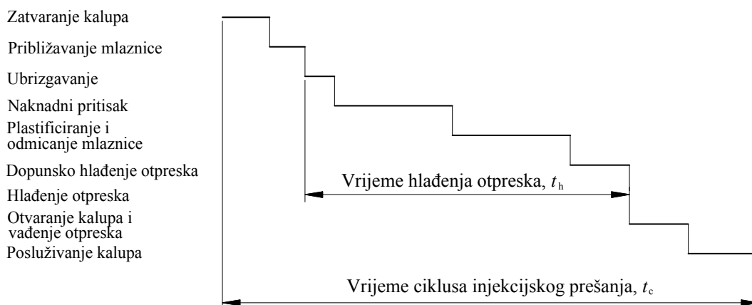
Slika 5.22. Analiza ciklusa injekcijskog prešanja [3]
