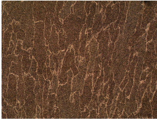
Slika 7.75 Mikrostruktura zavara čelika TStE420, povećanje 200x, vrijeme hlađenja \Delta t_{8/5}=10s
