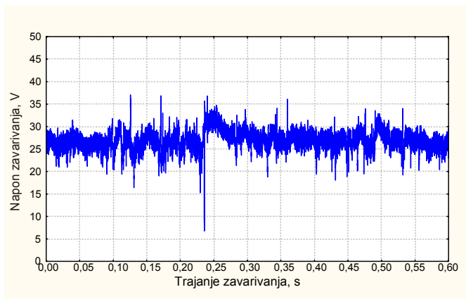
Slika 7.48 Promjena napona u funkciji od vremena pri MAG-postupku zavarivanja
