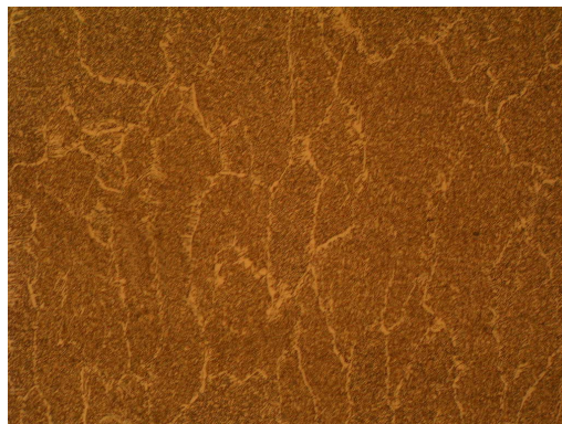
Slika 7.74 Mikrostruktura zavara čelika TStE420, povećanje 200x, vrijeme hlađenja \Delta t_{8/5}=5s
