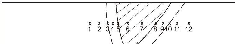
Slika 7.55 Mjerenje tvrdoće HV10 po presjeku zavarenog spoja
