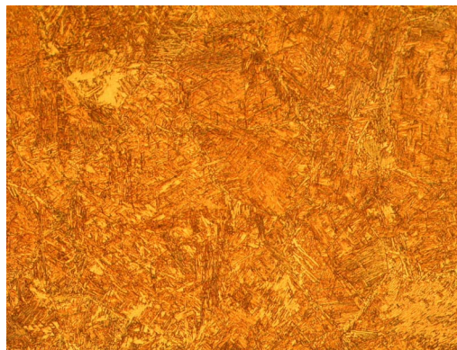
Slika 7.31 Mikrostruktura ZUT-a čelika TStE420, povećanje 200x, vrijeme hlađenja \Delta t_{8/5}=10s
