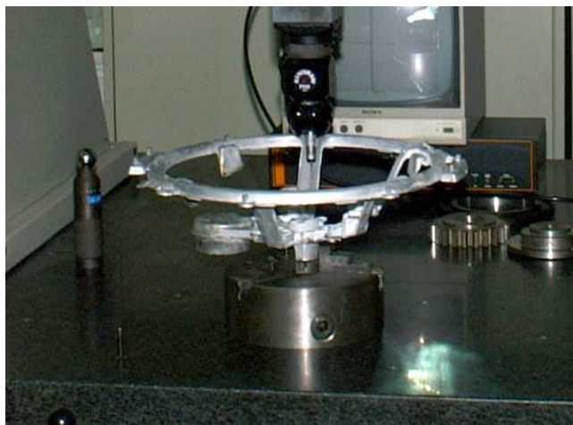
Slika 58. Prihvat mjernog objekta
