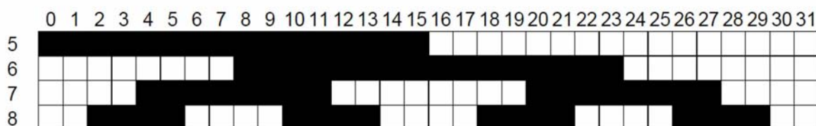
Slika 26: Princip metode Gray koda
