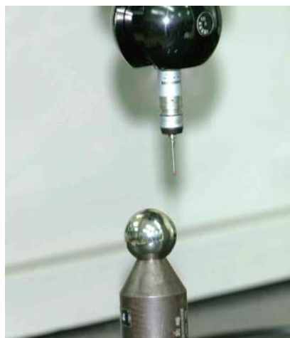
Slika 57. Kalibracija ticala kuglastim kalibrom
